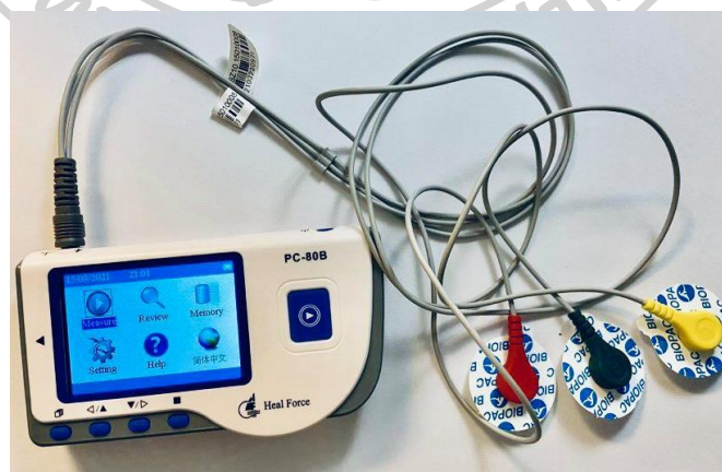
รูปที่ 4.6 เครื่อง PC-80B Easy ECG Monitor สำหรับการบันทึกสัญญาณไฟฟ้าหัวใจ
