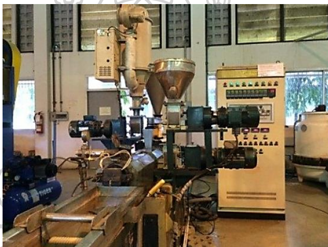
ภาพที่ 3.4 เครื่องอัดรีดแบบสกรูคู่ (twin screw extruder)
