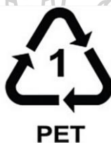
ภาพที่ 2.5 สัญลักษณ์มาตรฐานของพอลิเอทิลีนเทเรฟทาเลต [13]
