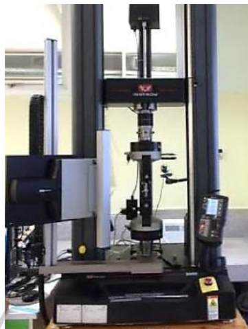
ภาพที่ 3.8 เครื่องทดสอบสมบัติของวัสดุแบบทั่วไป (Universal testing machine)
