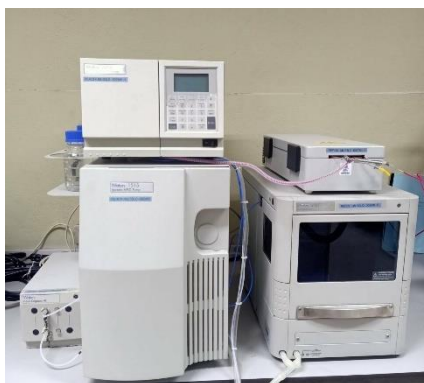
รูปที่ 3.14 เครื่อง Gel permeation chromatography (GPC) ของ Waters 1515 โดยมี Waters 2414 Reflective Index เป็น Detector
