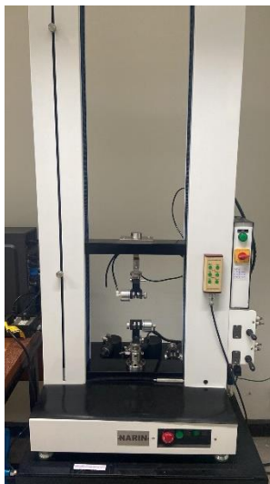
รูปที่ 3.11 เครื่องทดสอบสมบัติการดึงยืด (Universal Testing Machine)
