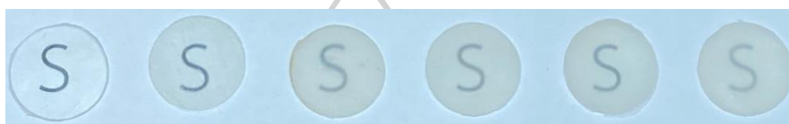
ภาพที่ 4.35 แสดงตัวอย่างชิ้นงานการทดสอบ XRD โดยตัวอย่างคือ neat PLA 3251D, crystallized PLA 3251D, 3251D /LAK0.5, 3251D /LAK1.0, 3251D /SSIPAO.5 และ 3251D /SSIPAO.1.0 โดยเรียงจากซ้ายไปขวาตามลำดับ
