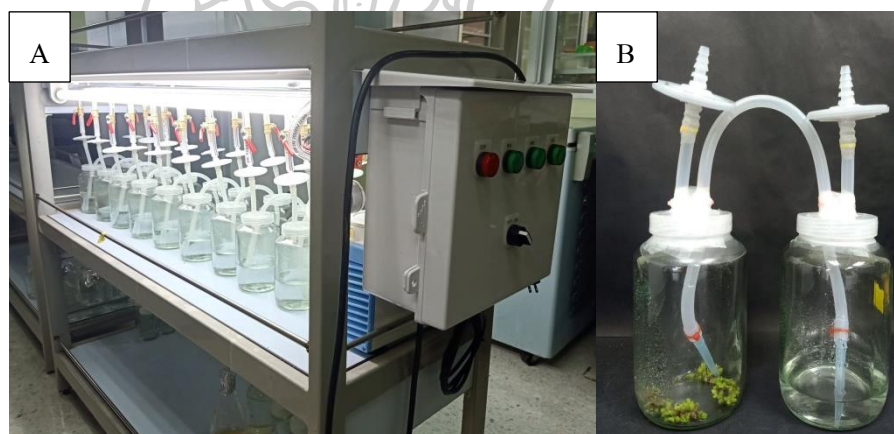
ภาพที่ 25 ระบบถังปฏิกรณ์ชีวภาพแช่ชั่วคราวแบบ Twin jar A) Twin jar 1 ระบบ B) Twin jar 1 ชุด
