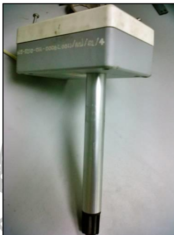
รูปที่ 3.5 เครื่องวัดความชื้นสัมพัทธ์ของอากาศ
