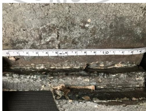
ภาพที่ 62 การบันทึกภาพชิ้นงานทดลองของการเกิดสนิม ที่มา: ถ่ายโดยผู้วิจัย, เมื่อวันที่ 19 พฤษภาคม 2022
