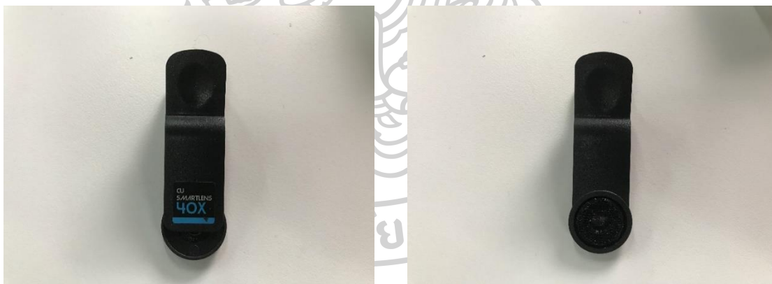
ภาพที่ 32 รูปด้านหน้าและด้านหลังของกล้องขยายขนาดที่ใช้ในการตรวจสอบสภาพสนิม ที่มา : ถ่ายโดยผู้วิจัย, เมื่อวันที่ 2 มีนาคม 2022
