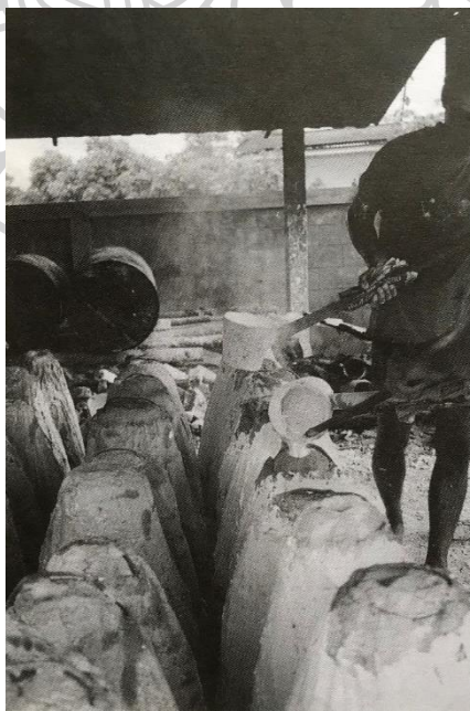
ภาพที่ 5 การเทสำริดเหลวเข้าสู่แม่พิมพ์
