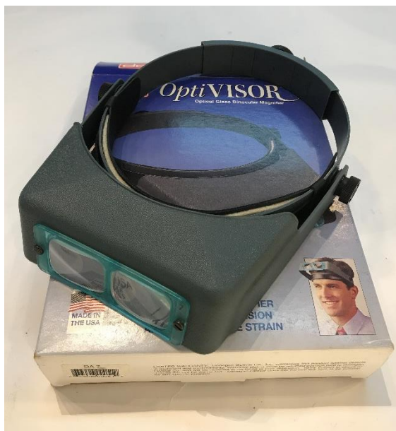
ภาพที่ 58 แว่นขยายสำหรับตรวจบริเวณที่มีลวดลายหรือซอกต่าง ๆ บนชิ้นงาน ที่มา: ถ่ายโดยผู้วิจัย, เมื่อวันที่ 20 พฤษภาคม 2022
