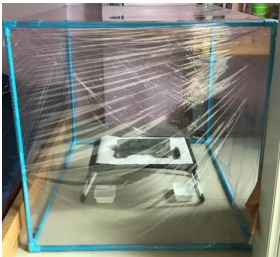
ภาพที่ 60 กล่องพลาสติกที่ทำการทดลองสำรวจเพื่อให้เกิดสนิม ที่มา: ถ่ายโดยผู้วิจัย, เมื่อวันที่ 20 กันยายน 2021
