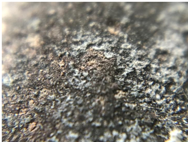
ภาพที่ 63 การใช้กล้องขยายขนาด 40X เพื่อตรวจสอบลักษณะของสำริด ที่มา: ถ่ายโดยผู้วิจัย, เมื่อวันที่ 19 พฤษภาคม 2022
