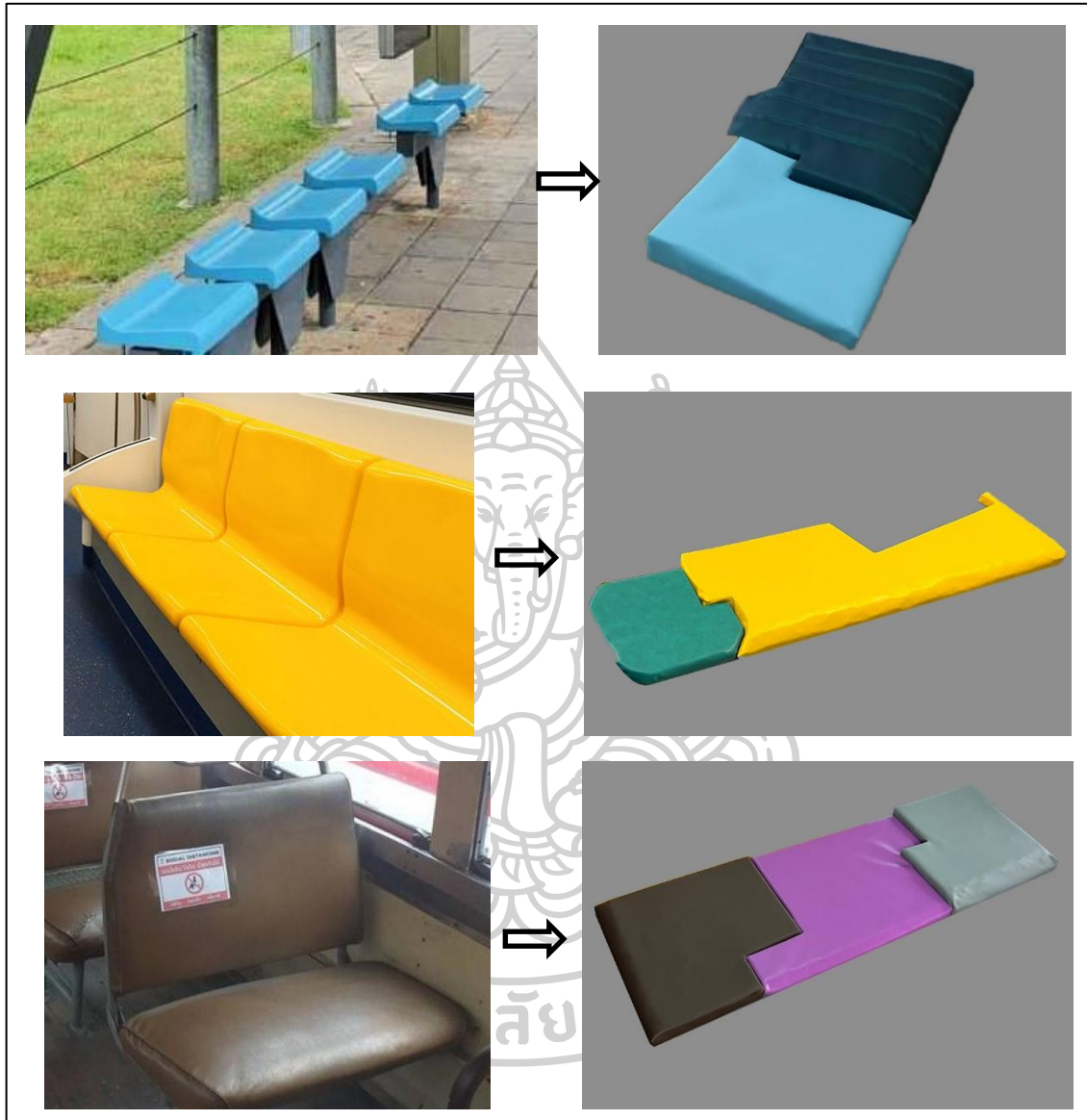
ภาพที่ 38 ภาพเย็บผ้าหนังหุ้มเบาะพองน้ำให้คงรูปทรงวัตถุเก้าอี้ของรถโดยสารสาธารณะ ที่มารูปภาพ : ผู้วิจัย
