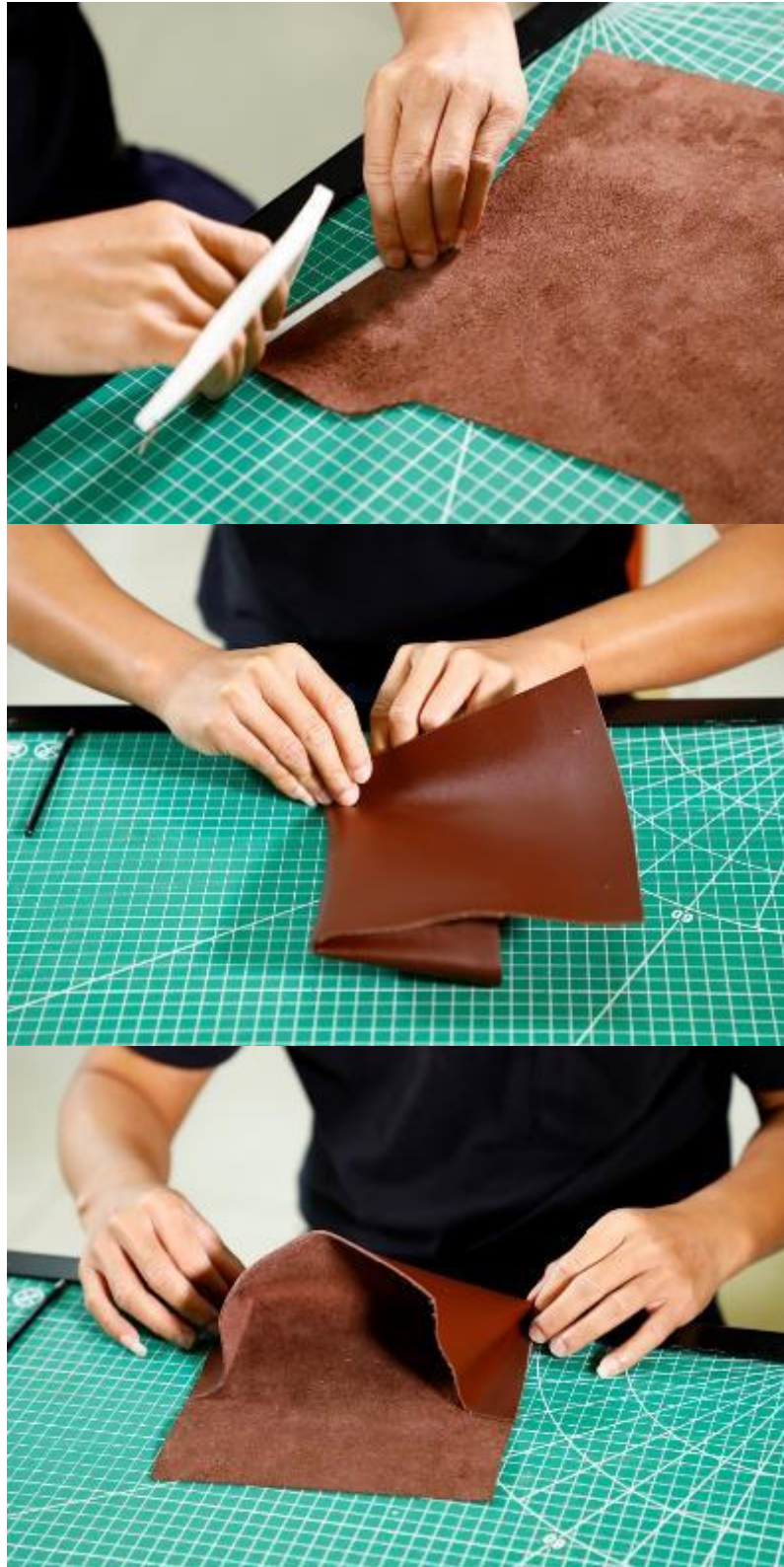
ภาพที่ 110 ภาพแสดงการตีเทพกาวสองหน้าละลายน้ำสำหรับงานผ้าบนหนังปกโครม
