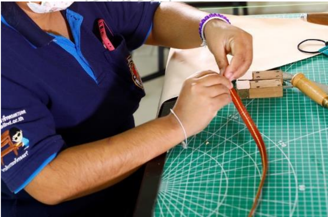
ภาพที่ 130 ภาพแสดงการเย็บเข็มขัดแบบคั่นถอยหลัง
