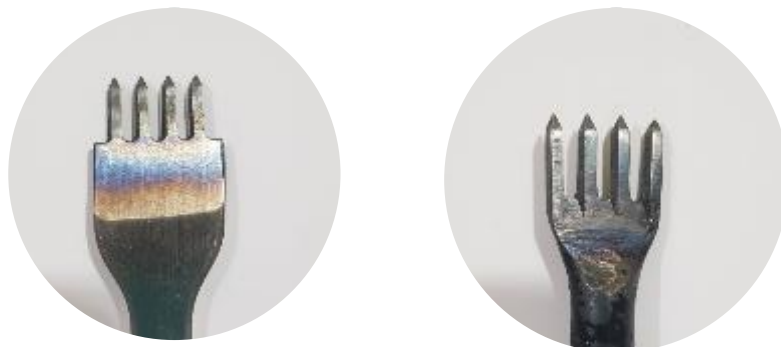
ภาพที่ 69 ปลายส้อมตอกที่ผ่านการชุบแข็ง
