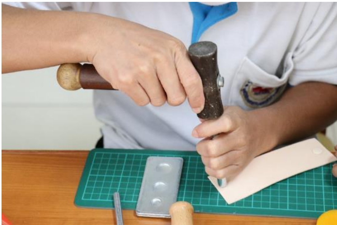
ภาพที่ 117 ภาพแสดงการตอกติดกระดุมแป๊ก
