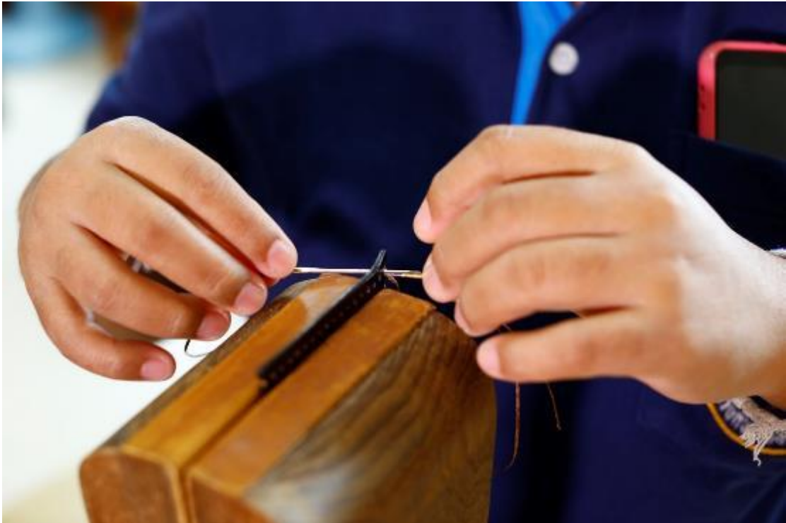
ภาพที่ 129 ภาพแสดงการเย็บเข็มขัดแบบใช้เข็มสวน 2 ทาง
