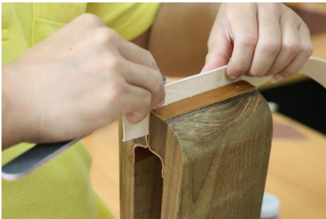
ภาพที่ 124 การขัดขอบหนังด้วยกระดาษทราย
