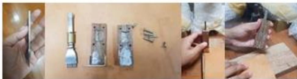
ภาพที่ 66 ผลิตต้นแบบส้อมตอกหรือเครื่องมือเจาะนำพร้อมทดลองใช้
