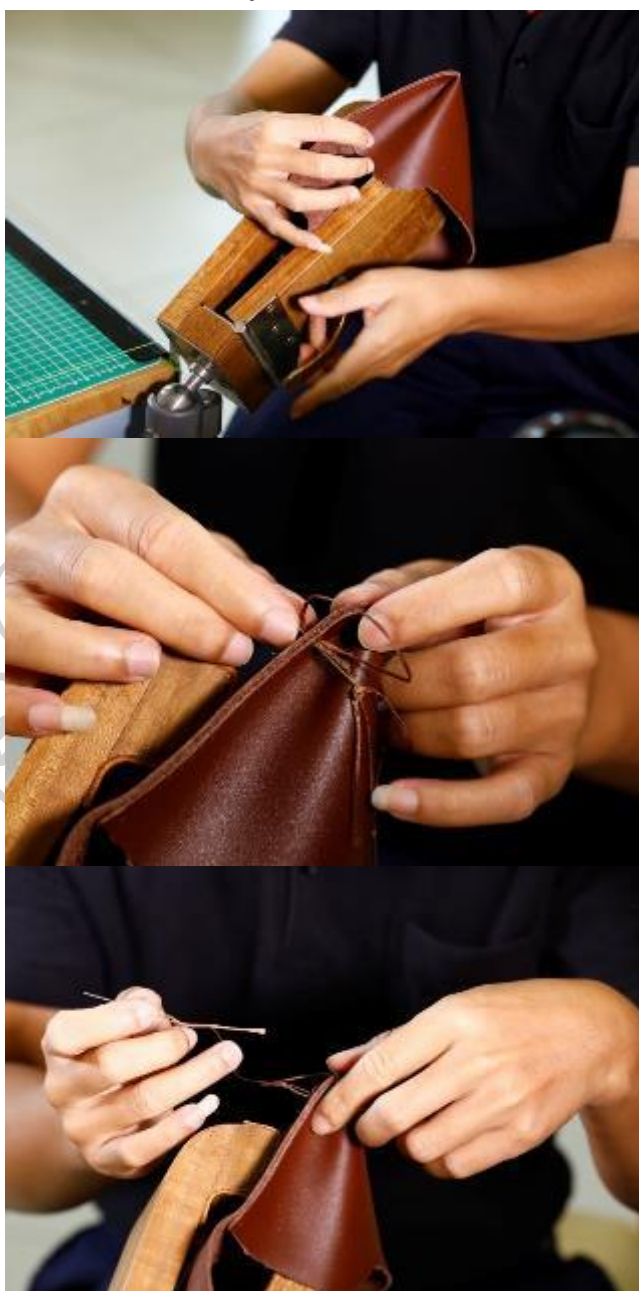
ภาพที่ 113 ภาพแสดงการยึดจับแผ่นหนังนึ่งขึ้นรูปกระเป๋าด้วยไม้หนีบหนังปรับองศาและการเย็บ
