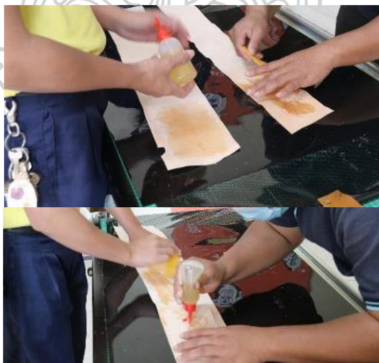
ภาพที่ 120 ภาพแสดงการทากาวยางประกบแผ่นหนัง
