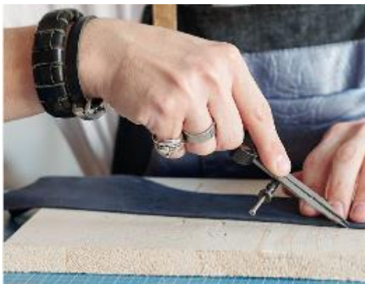
ภาพที่ 18 วงเวียนที่ใช้ในงานเครื่องหนัง (Junto, 2022)
