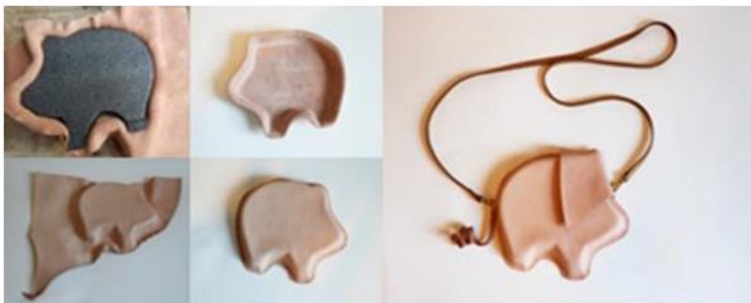
ภาพที่ 85 ต้นแบบผลิตภัณฑ์ชิ้นรูปสามมิติโดยใช้แม่พิมพ์
