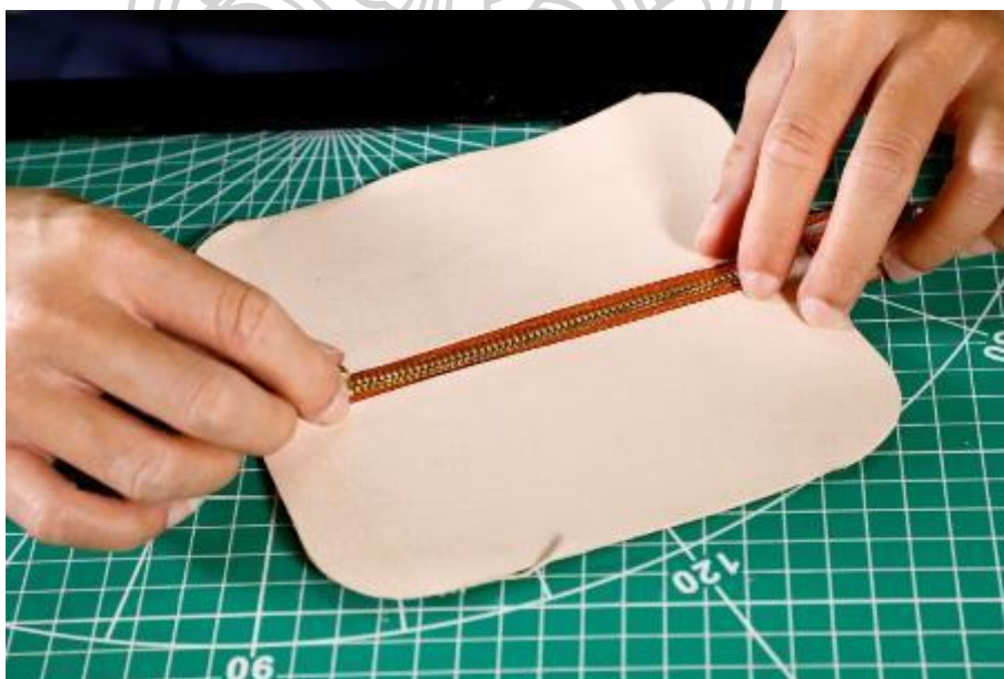
ภาพที่ 104 การวางตำแหน่งซิบบนช่องเจาะแผ่นหนัง
