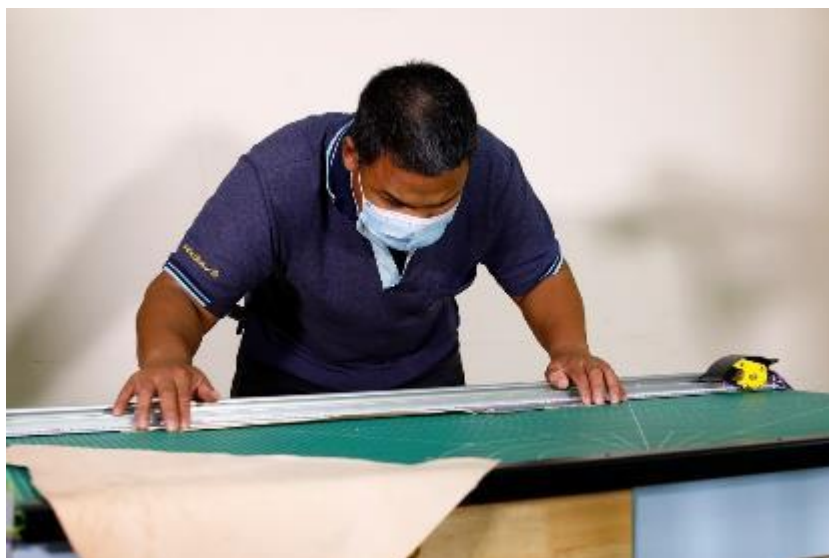
ภาพที่ 119 ภาพแสดงการสอดแผ่นหนังใต้รางเลื่อนเพื่อตัด
