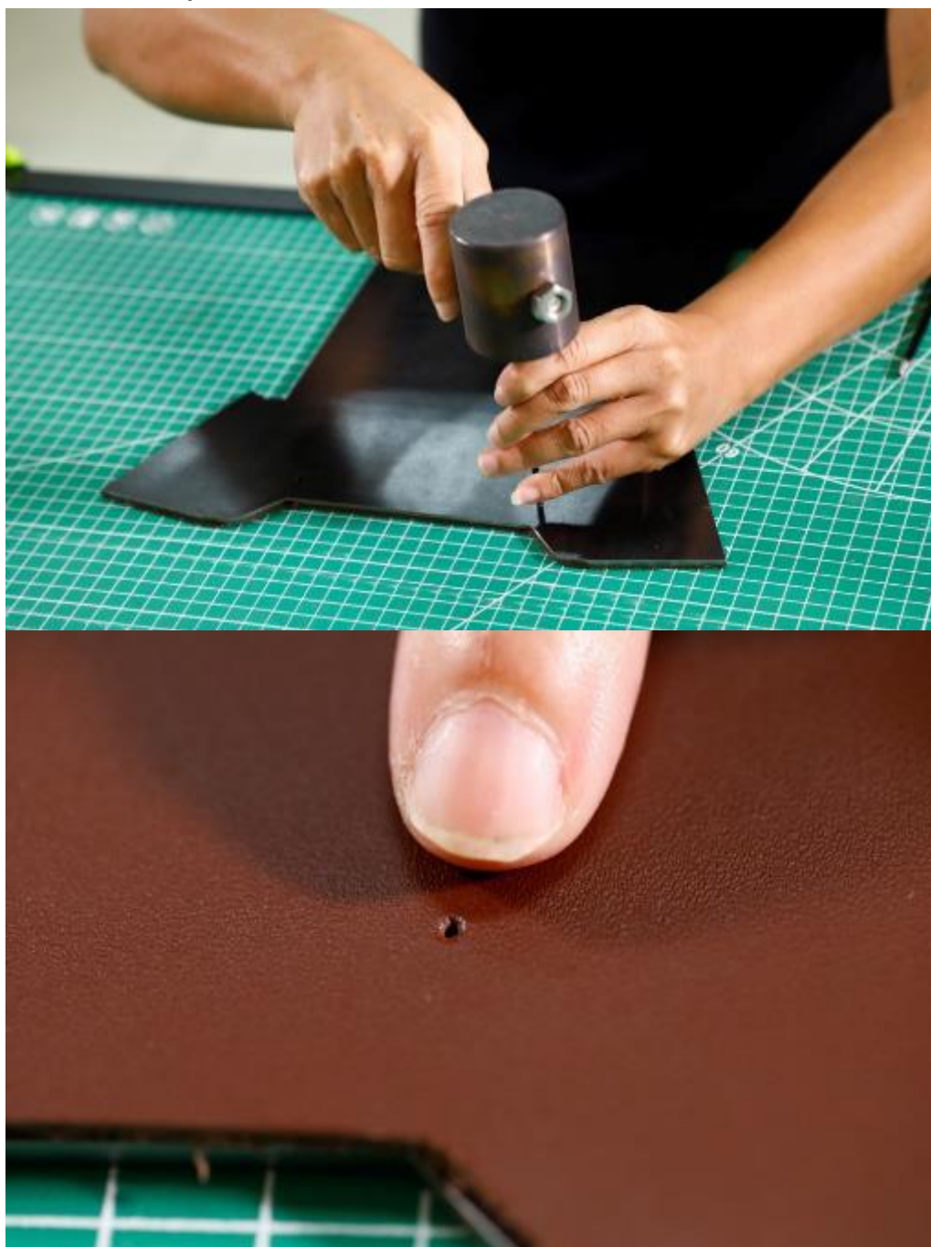
ภาพที่ 109 การเจาะรูแผ่นหนังตามแม่แบบโลหะ
