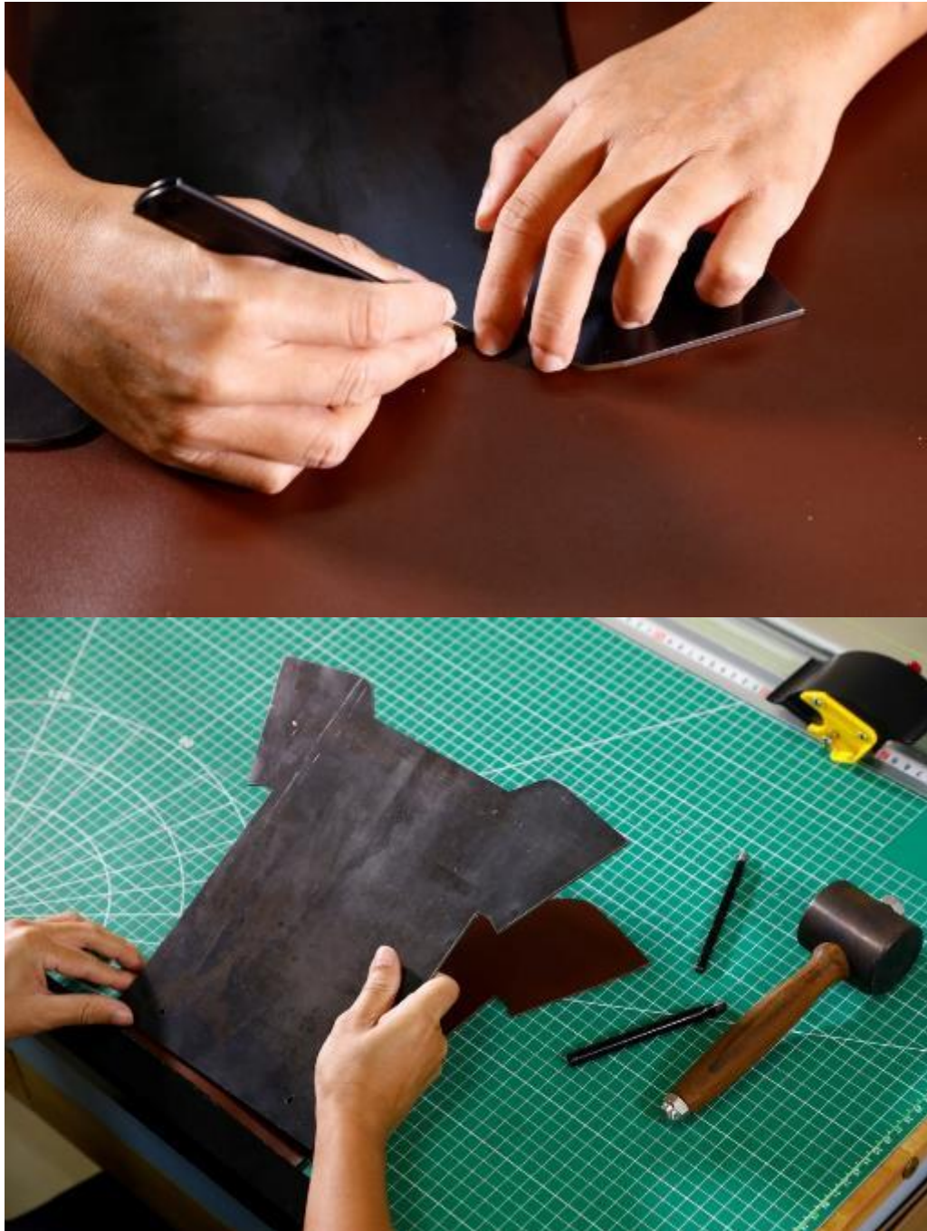
ภาพที่ 108 การตัดแผ่นหนังปกโครม 2
