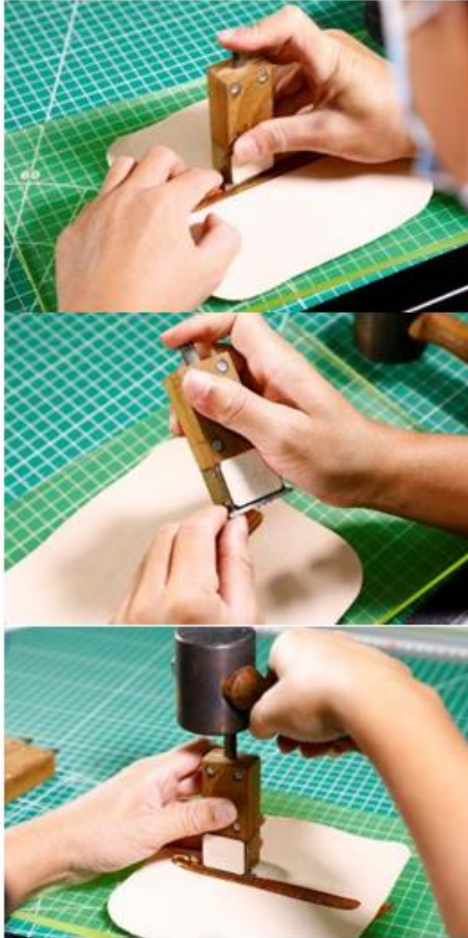
ภาพที่ 105 กระบวนการตอกเจาะนำแผ่นหนังประกอบซิป
