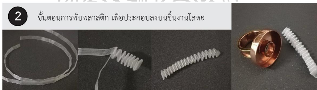
ภาพที่ 76 ขั้นตอนการขึ้นชิ้นส่วนพลาสติกเครื่องประดับชุดที่ 1 (แหวนวงที่ 2)
