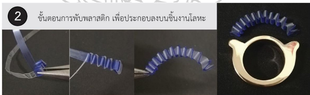
ภาพที่ 74 ขั้นตอนการขึ้นชิ้นส่วนพลาสติกเครื่องประดับชุดที่ 1 (แหวนวงที่ 1)
