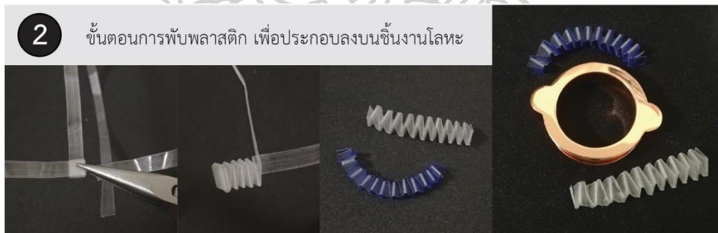
ภาพที่ 80 ขั้นตอนการขึ้นชิ้นส่วนพลาสติกเครื่องประดับชุดที่ 1 (แหวนวงที่ 4)
