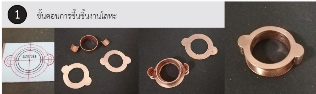
ภาพที่ 79 ขั้นตอนการขึ้นชิ้นงานโลหะเครื่องประดับชุดที่ 1 (แหวนวงที่ 4)
