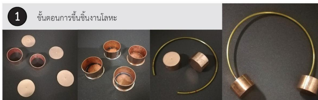
ภาพที่ 87 ขั้นตอนการขึ้นชิ้นงานโลหะเครื่องประดับชุดที่ 2 (กำไลข้อมือ)
