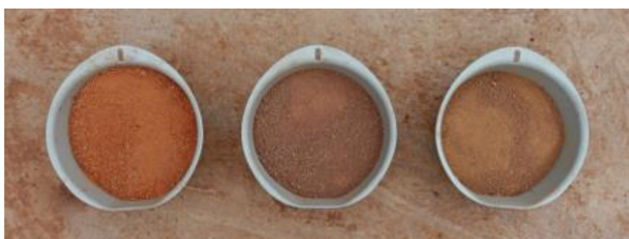
ภาพที่ 77 วัสดุดิบทั้ง 3 ชนิด ที่ผ่านกระบวนการบดด้วยเครื่องบด Jaw Crusher
