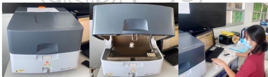
ภาพที่ 91 การทดสอบสมบัติทางเคมี ด้วยเทคนิคเอกซเรย์ฟลูออเรสเซนซ์
