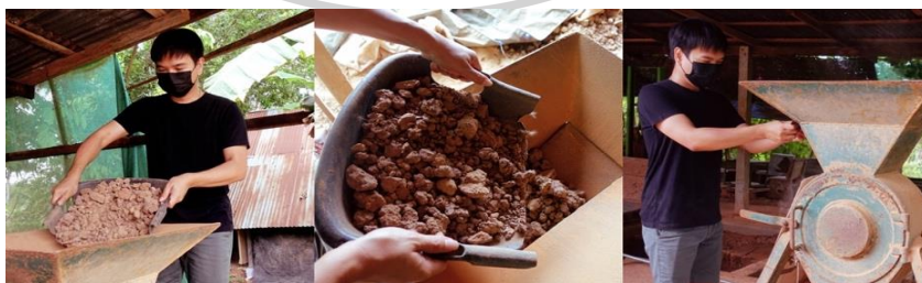
ภาพที่ 75 การบดดินดานเหนียวด้วยเครื่องบด Jaw Crusher
