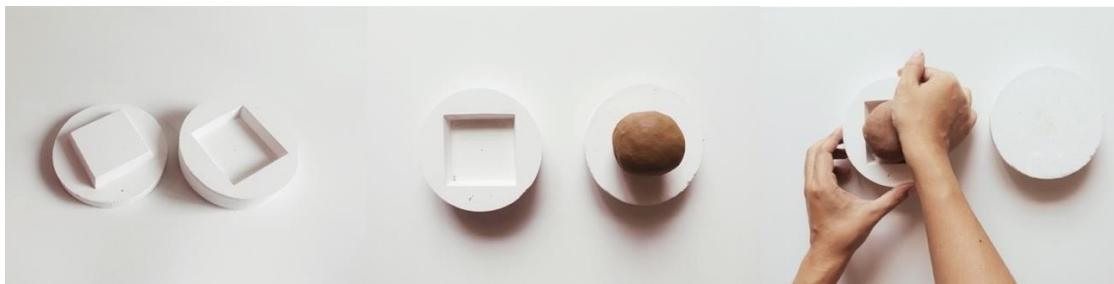
ภาพที่ 97 กระบวนการอัดดินลงในแม่พิมพ์ปูนปลาสเตอร์
