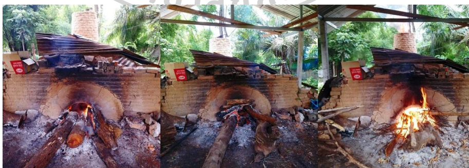
ภาพที่ 88 การเผาผลิตภัณฑ์ด้วยเตาฟืน
