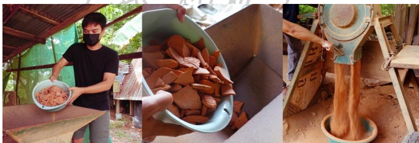
ภาพที่ 74 การบดดินแข็งด้วยเครื่องบด Jaw Crusher
