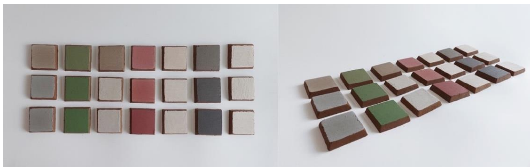
ภาพที่ 107 แผ่นทดลองก่อนนำไปเผาในอุณหภูมิ 900 องศาเซลเซียส
