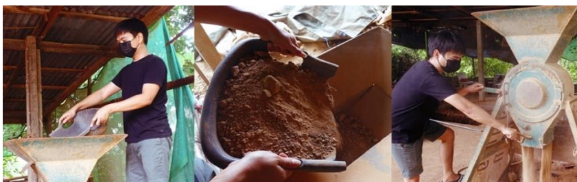
ภาพที่ 76 การบดทรายผ่านเกวียนด้วยเครื่องบด Jaw Crusher
