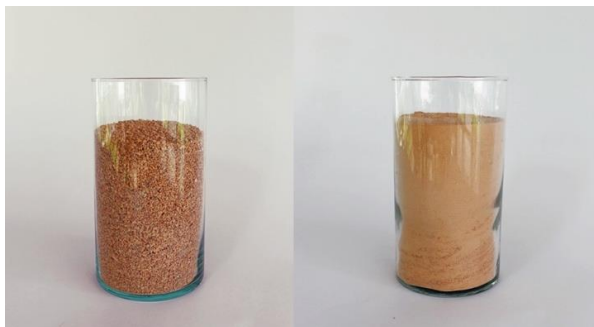
ภาพที่ 79 ดินเชื้อแบบหยาบและดินเชื้อแบบละเอียดที่ผ่านกระบวนการร่อน
