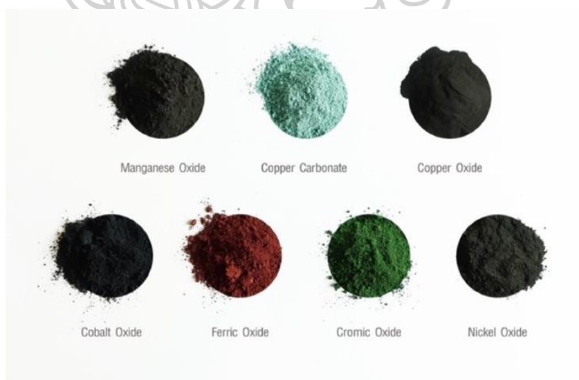
ภาพที่ 104 สารให้สีประเภทสีออกไซด์ (Oxide)
