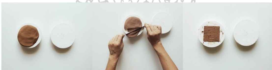
ภาพที่ 98 กระบวนการอัดดินลงในแม่พิมพ์ปูนปลาสเตอร์
