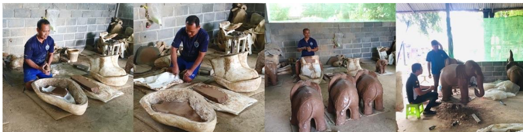
ภาพที่ 14 การปั้นหรือการขึ้นรูปด้วยวิธีการอัดแม่พิมพ์
