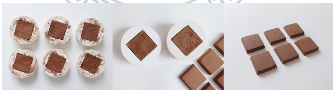
ภาพที่ 99 กระบวนการอัดดินลงในแม่พิมพ์ปูนปลาสเตอร์
