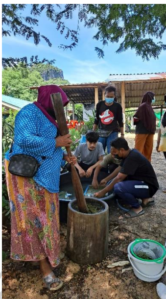
ภาพที่ 134 ช่างสานกำลังตำเส้นใยที่ผ่านการต้มแล้วเพื่อให้เกิดเป็นเยื่อสำหรับเป็นวัสดุในการทำกระดาษ (ภาพโดย สรวุฒ กิ่งนสุวรรณ, กรกฎาคม 2565)
