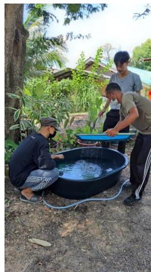
ภาพที่ 102 (ซ้าย) การนำเยื่อเตยลงตะแกรง/เฟรมสำหรับทำกระดาษ (1)
