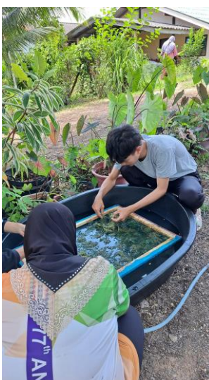
ภาพที่ 102 (ซ้าย) การนำเยื่อเตยลงตะแกรง/เฟรมสำหรับทำกระดาษ (1)
