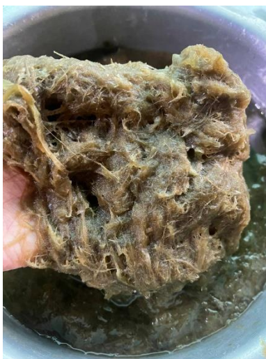
ภาพที่ 97 เนื้อเหี่ยวเตยที่ผ่านกระบวนการตำและการปั่นก่อนนำไปใช้ขึ้นแบบชิ้นงาน (ภาพโดย สรารุท กลิ่นสุวรรณ , มิถุนายน 2565)
