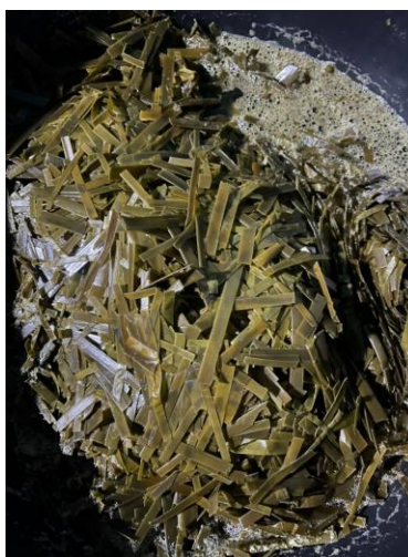
ภาพที่ 94 เศษเส้นตอกเตยที่อยู่ระหว่างการต้มและมีการเติมสารโซดาไฟในช่วงที่น้ำเดือดเพิ่มเติม เพื่อเร่งปฏิกิริยาการย่อยเส้นใย (ภาพโดย สราวุธ กลิ่นสุวรรณ , มิถุนายน 2565)
