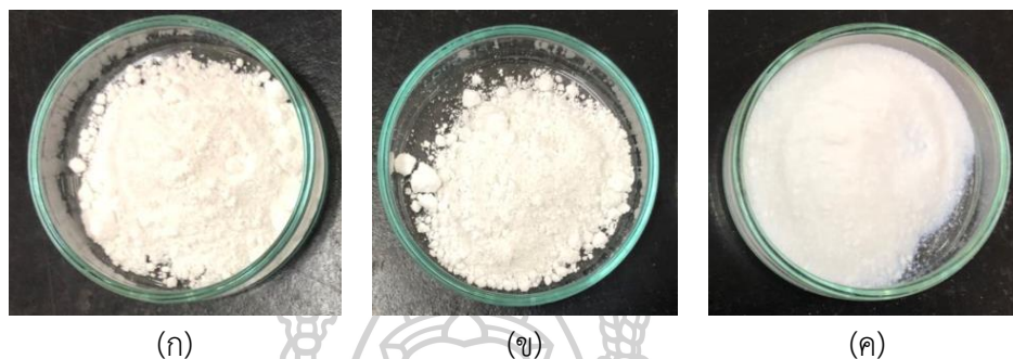
รูปที่ 58 แสดงลักษณะทางกายภาพของอนุภาคนาโนที่ได้หลังจากการเผาที่ 800^\circ\text{C}
