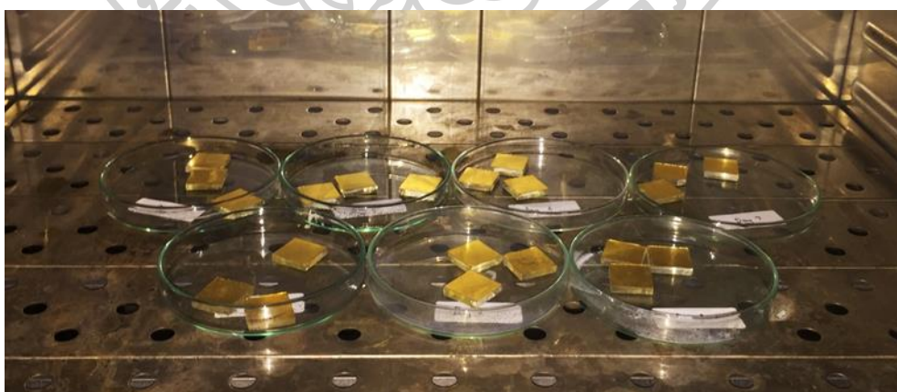
รูปที่ 28 แสดงการทดสอบการทนความร้อนเป็นเวลา 7 วันของโมเสกที่เคลือบแล้ว
