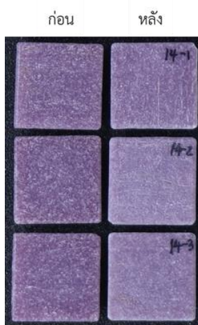
รูปที่ 70 แสดงแผ่นโมเสกก่อนและหลังพ่นเคลือบด้วย 14 phr HFS (ทดสอบความโปร่งใส)
