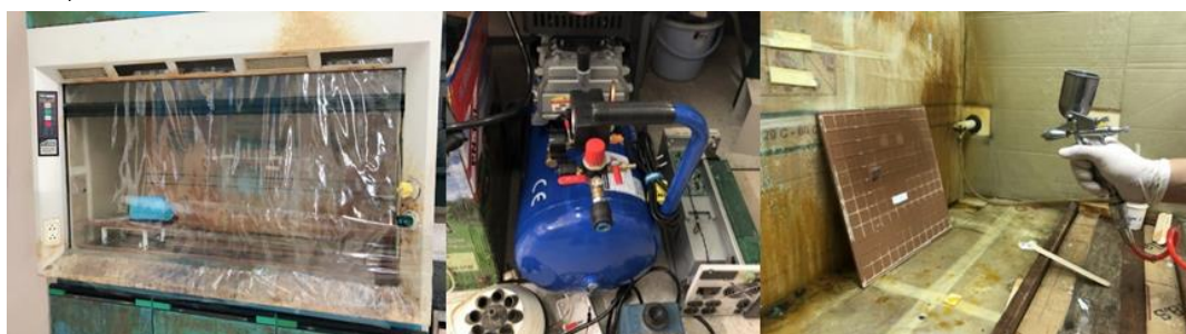
รูปที่ 23 อุปกรณ์ที่ใช้พ่นเคลือบและลักษณะการพ่นเคลือบ
