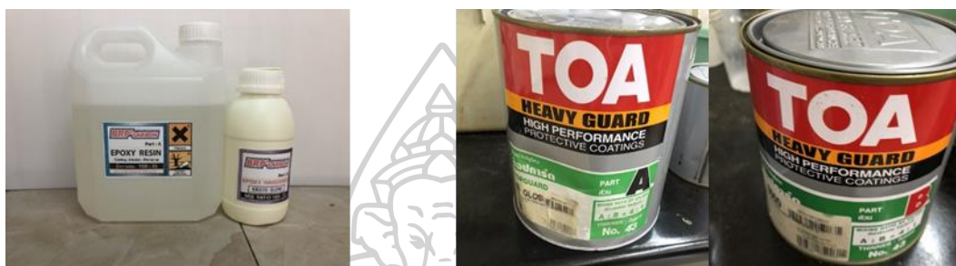
รูปที่ 22 แสดงสารยึดเกาะที่ใช้ในงานวิจัย (ซ้าย) อีพ็อกซีเรซิน (ขวา) พอลิยูรีเทน
