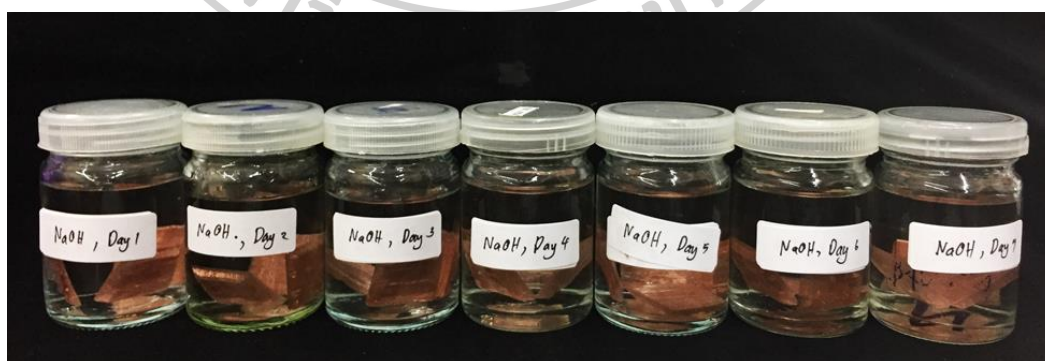
รูปที่ 27 แสดงการทดสอบการทนเบสเป็นเวลา 7 วันของโมเสกที่เคลือบแล้ว
