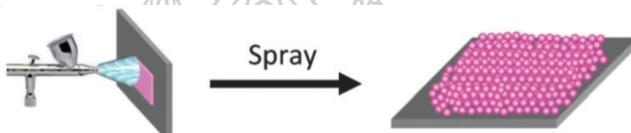
รูปที่ 11 แสดงวิธีพ่นเคลือบแบบ Conventional Air Spray [30]
