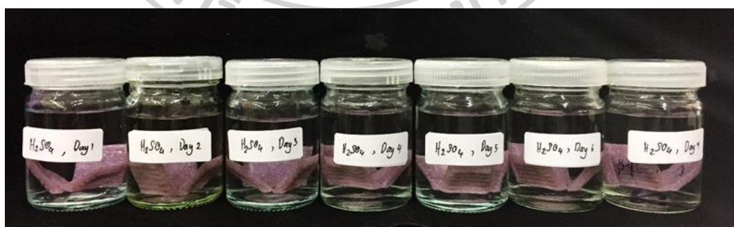
รูปที่ 26 แสดงการทดสอบการทนกรดเป็นเวลา 7 วันของโมเสกที่เคลือบแล้ว
