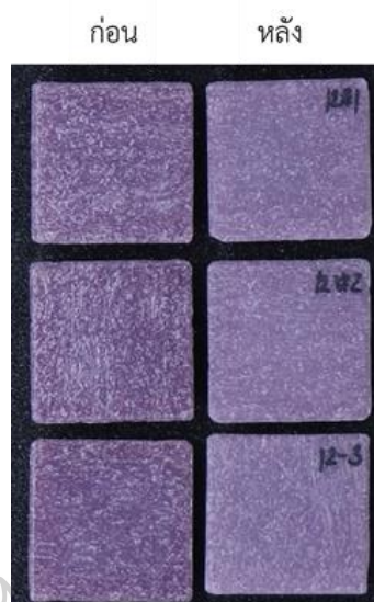
รูปที่ 69 แสดงแผ่นโมเสกก่อนและหลังพ่นเคลือบด้วย 12 phr HFS (ทดสอบความโปร่งใส)
