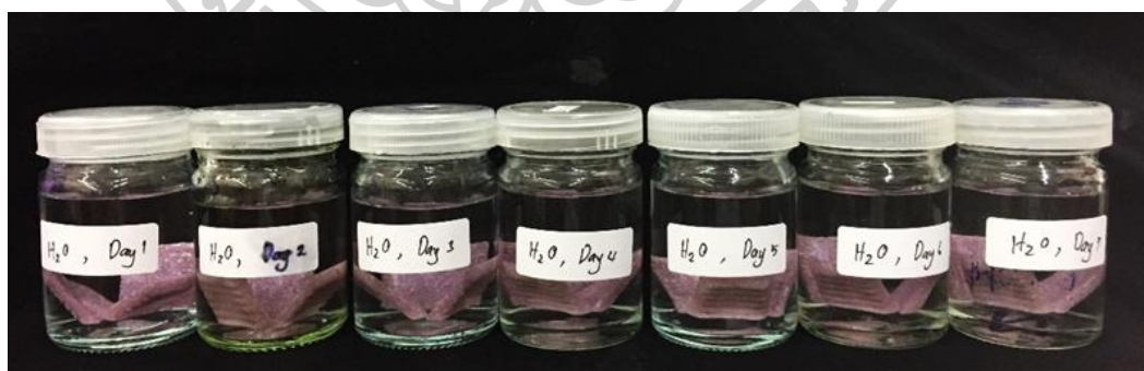
รูปที่ 25 แสดงการทดสอบการทนน้ำเป็นเวลา 7 วันของโมเสกที่เคลือบแล้ว
