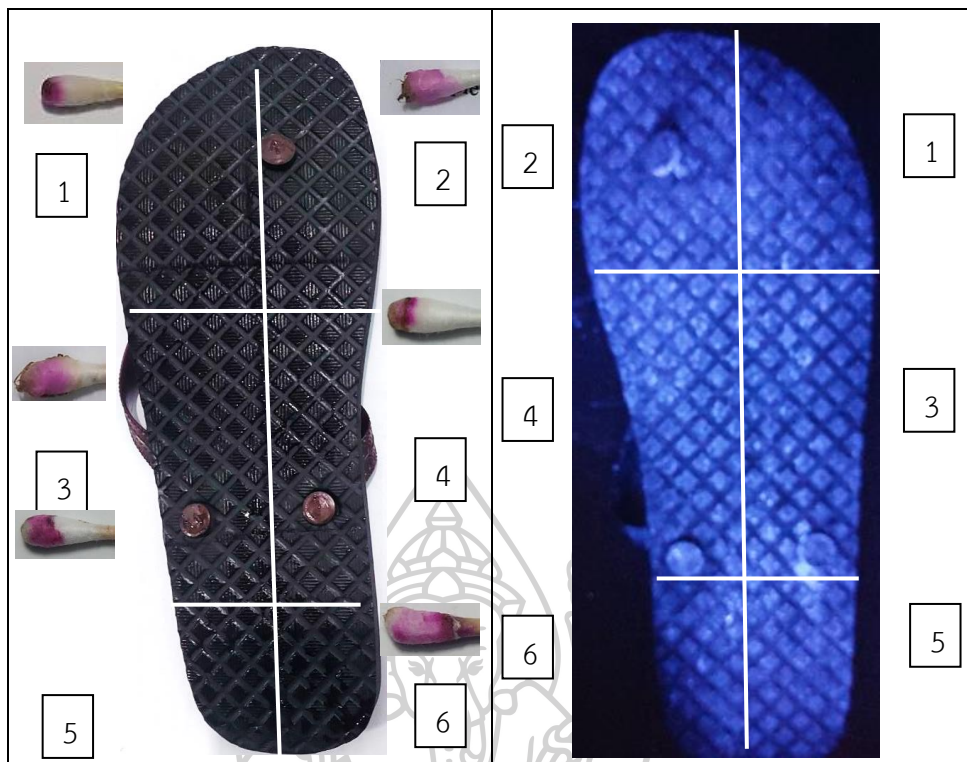
รูปที่ 28 แสดงผลการทดสอบด้วยฟีนอล์ฟทาลินและลูมินอลหลังจากแช่ด้วยน้ำยาทำความสะอาด ห้องน้ำ จำนวน 0 ครั้งของการแช่
