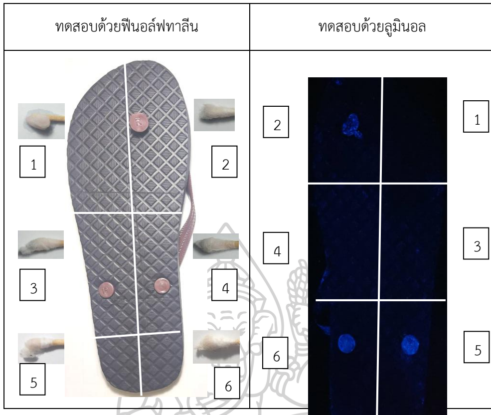
รูปที่ 35 แสดงผลการทดสอบด้วยฟีนอล์ฟทาลีนและลูมินอลหลังจากแช่ด้วยน้ำยาทำความสะอาด ห้องน้ำ จำนวน 20 ครั้งของการแช่
