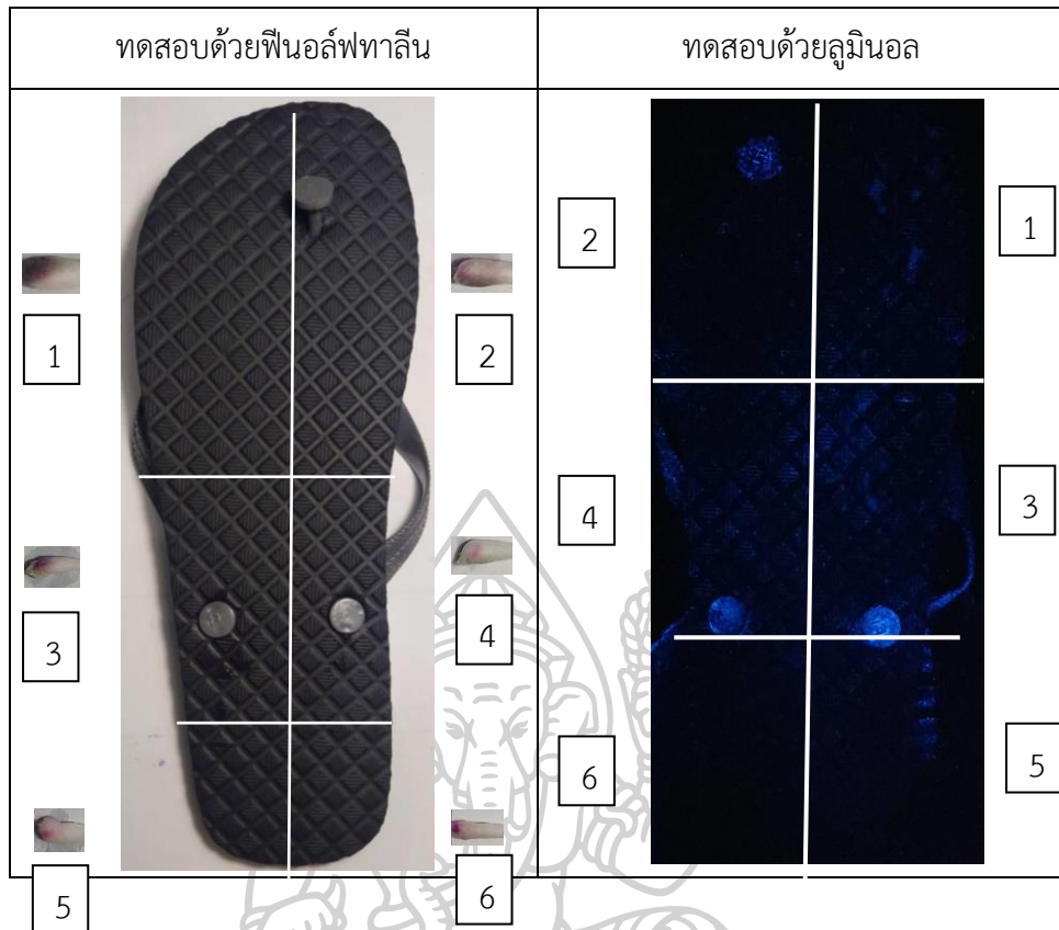
รูปที่ 33 แสดงผลการทดสอบด้วยฟีนอล์ฟทาลีนและลูมิโนลหลังจากแช่ด้วยน้ำยาทำความสะอาด ห้องน้ำ จำนวน 7 ครั้งของการแช่
