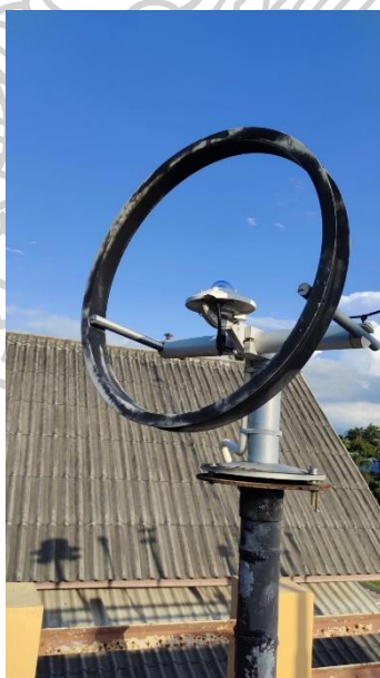
รูปที่ 52 เครื่องวัดรังสีกระจาย (เครื่องไพราโนมิเตอร์กับังแหวนบังรังสีตรง ของ Kipp & Zonen รุ่น CM21) ที่สถานีศูนย์อุตุนิยมวิทยาภาคใต้ฝั่งตะวันออก จังหวัดสงขลา
