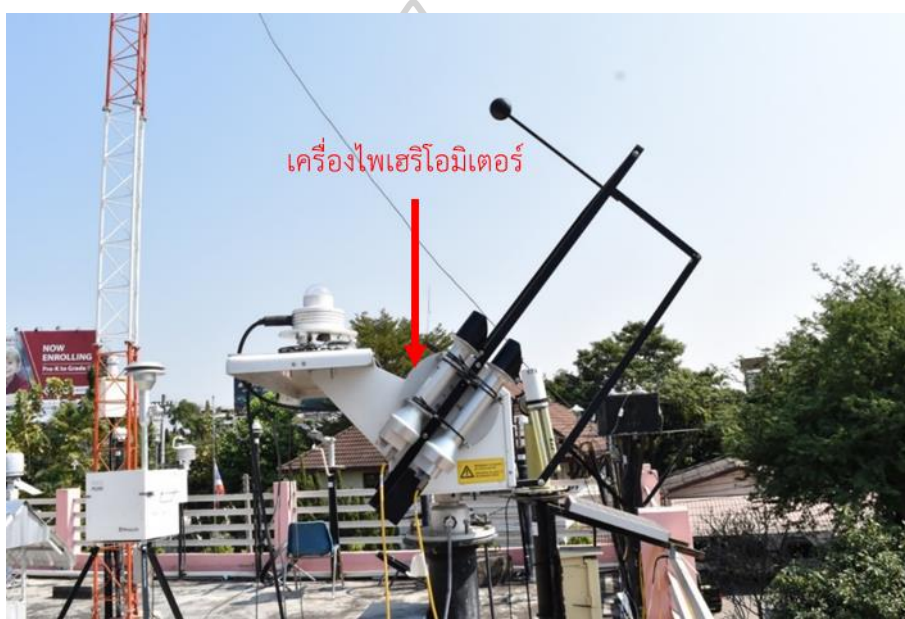
รูปที่ 53 เครื่องไพเฮริโอมิเตอร์ ที่สถานีศูนย์อุตุนิยมวิทยาภาคเหนือ จังหวัดเชียงใหม่
