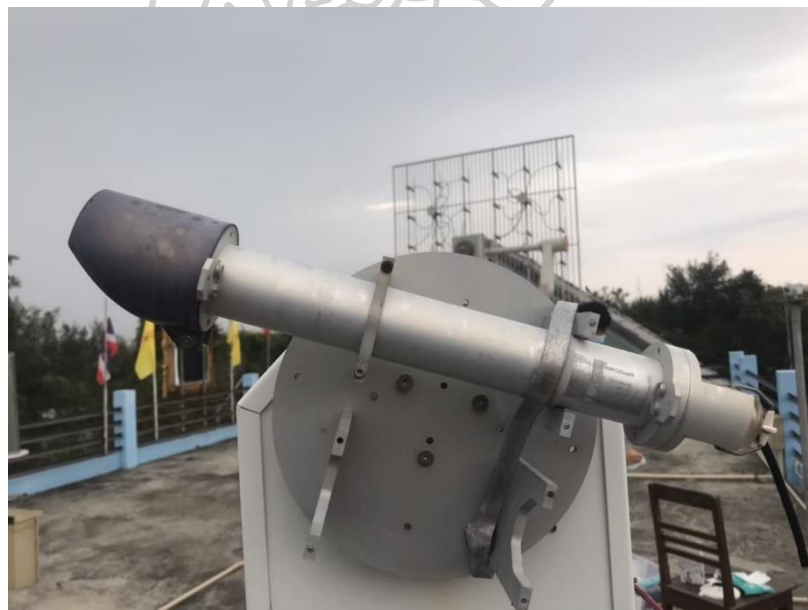
รูปที่ 61 เครื่องไพเฮริโอมิเตอร์ ที่สถานีอุตุนิยมวิทยาประจวบคีรีขันธ์
