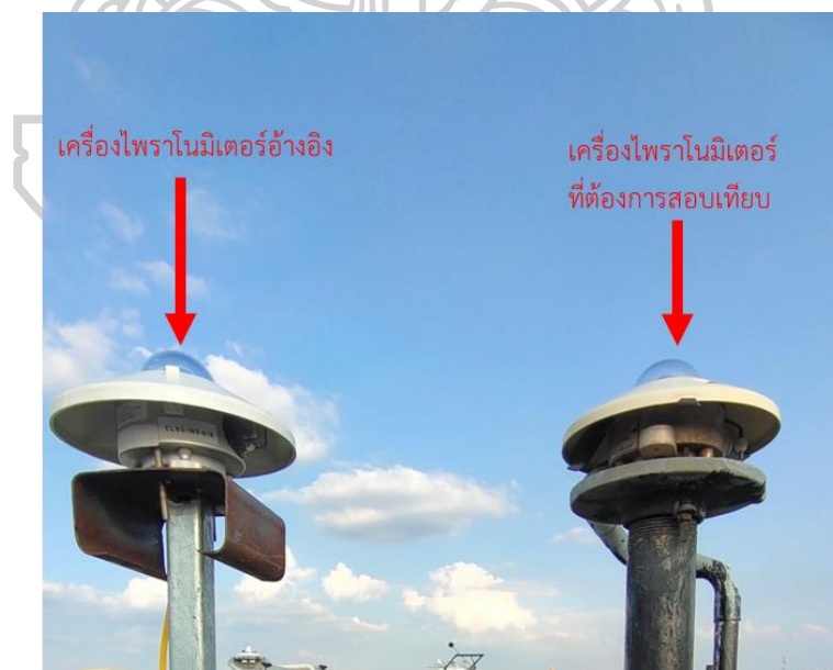
รูปที่ 67 ตัวอย่างการสอบเทียบเครื่องวัดรังสีรวม ที่สถานีคณะวิทยาศาสตร์ มหาวิทยาลัยศิลปากร จังหวัดนครปฐม
