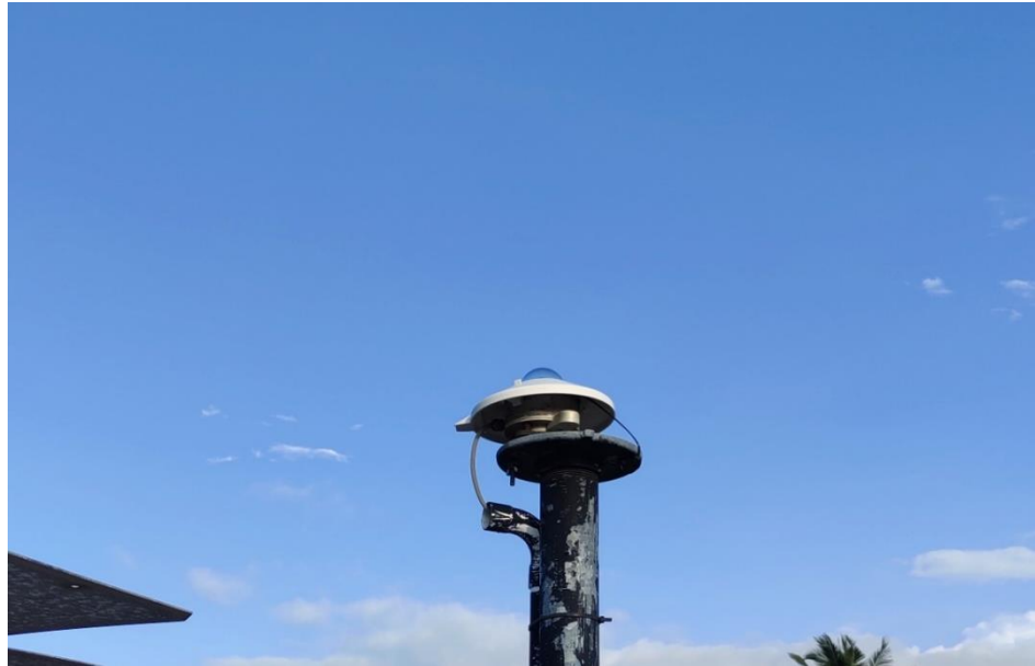
รูปที่ 37 เครื่องวัดรังสีรวมของ Kipp & Zonen รุ่น CM21 ที่สถานีศูนย์อุตุนิยมวิทยาภาคใต้ฝั่งตะวันออก จังหวัดสงขลา
