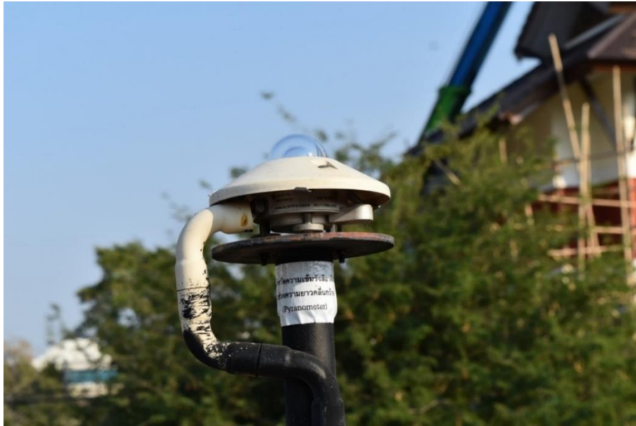
รูปที่ 31 เครื่องวัดรังสีรวมของ Kipp & Zonen รุ่น CM21 ที่สถานีศูนย์อุตุนิยมวิทยาภาคเหนือ จังหวัด เชียงใหม่
