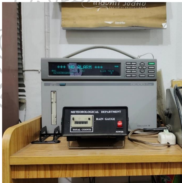
รูปที่ 42 เครื่องบันทึกข้อมูลของบริษัท Yokogawa รุ่น DC100 ที่สถานีอุตุนิยมวิทยานครสวรรค์
