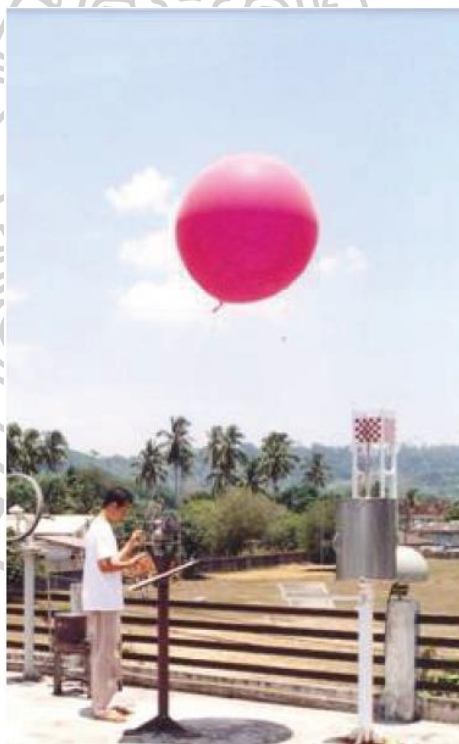
รูปที่ 21 การปล่อยบอลลูนตรวจอากาศที่ศูนย์อุตุนิยมวิทยาภาคใต้ฝั่งตะวันตก จังหวัดภูเก็ต คำนวณหาปริมาณไอน้ำในบรรยากาศได้
