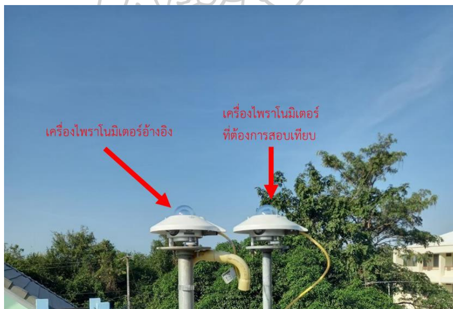
รูปที่ 73 ตัวอย่างการสอบเทียบเครื่องวัดรังสีรวม ที่สถานีอุตุนิยมวิทยาประจวบคีรีขันธ์
