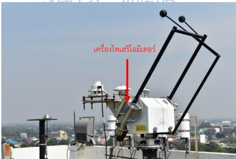
รูปที่ 55 เครื่องโฟเฮริโอมิเตอร์ ที่สถานีคณะวิทยาศาสตร์ มหาวิทยาลัยศิลปากร จังหวัดนครปฐม
