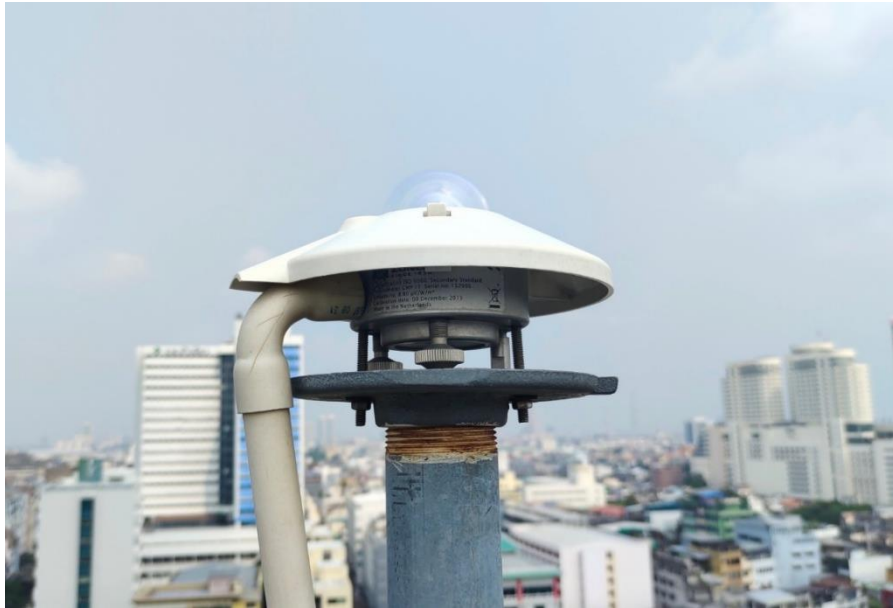
รูปที่ 39 เครื่องวัดรังสีรวมของ Kipp & Zonen รุ่น CMP11 ที่สถานีกรุงเทพ (กรมพัฒนาพลังงานทดแทน และอนุรักษ์พลังงาน กระทรวงพลังงาน กรุงเทพมหานคร)
