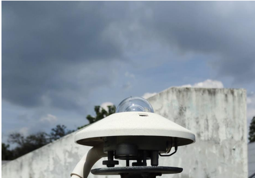
รูปที่ 41 เครื่องวัดรังสีรวมของ Kipp & Zonen รุ่น CMP11 ที่สถานีอุตุนิยมวิทยานครสวรรค์
