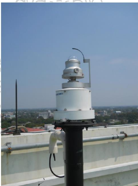
รูปที่ 26 กล้องถ่ายภาพท้องฟ้า ซึ่งติดตั้งที่สถานีวัดรังสีอาทิตย์ มหาวิทยาลัยศิลปากรจังหวัดนครปฐม
