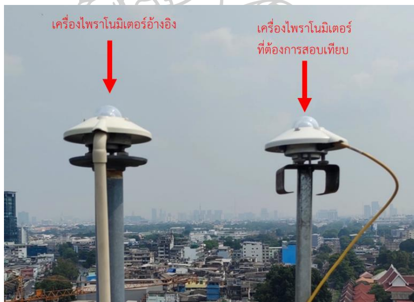
รูปที่ 69 ตัวอย่างการสอบเทียบเครื่องวัดรังสีรวม ที่สถานีอุตุนิยมวิทยากรุงเทพ (กรมพัฒนาพลังงานทดแทน และ อนุรักษ์พลังงาน กระทรวงพลังงาน กรุงเทพมหานคร)
