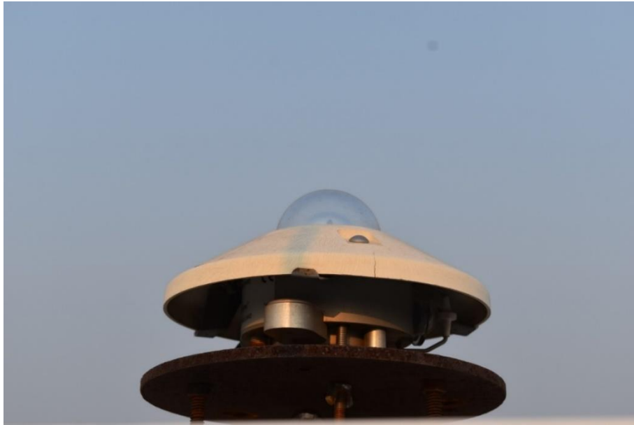
รูปที่ 33 เครื่องวัดรังสีรวมของ Kipp & Zonen รุ่น CM21 ที่สถานีศูนย์อุตุนิยมวิทยาภาคตะวันออกเฉียงเหนือตอนล่าง จังหวัดอุบลราชธานี
