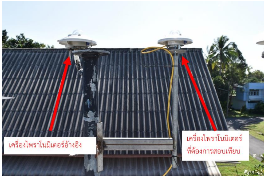
รูปที่ 68 ตัวอย่างการสอบเทียบเครื่องวัดรังสีรวม ที่สถานีศูนย์อุตุนิยมวิทยาภาคใต้ฝั่งตะวันออก จังหวัดสงขลา
