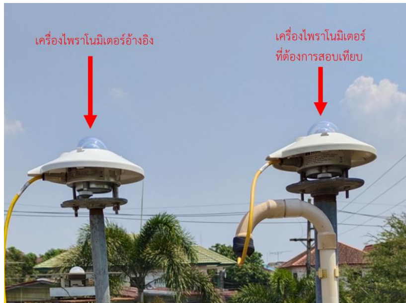
รูปที่ 72 ตัวอย่างการสอบเทียบเครื่องวัดรังสีรวม ที่สถานีอุตุนิยมวิทยานครราชสีมา
