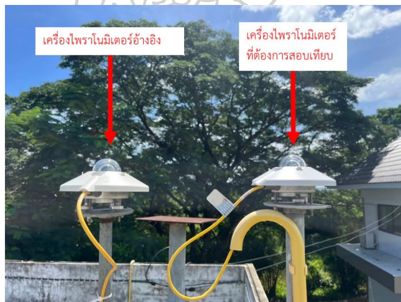
รูปที่ 71 ตัวอย่างการสอบเทียบเครื่องวัดรังสีรวม ที่สถานีอุตุนิยมวิทยาพบุรี
