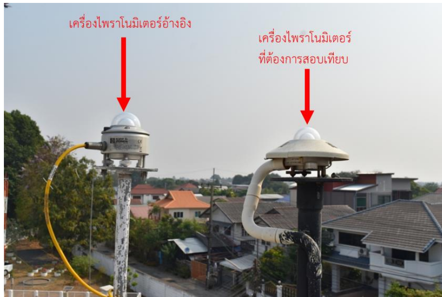
รูปที่ 66 ตัวอย่างการสอบเทียบเครื่องวัดรังสีรวม ที่สถานีศูนย์อุตุนิยมวิทยาภาคตะวันออกเฉียงเหนือ ตอนล่าง จังหวัดอุบลราชธานี
