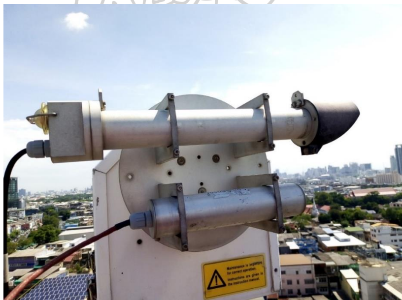
รูปที่ 57 เครื่องไพเอริโอมิเตอร์ ที่สถานีกรุงเทพฯ (กรมพัฒนาพลังงานทดแทน และอนุรักษ์พลังงาน กระทรวงพลังงาน กรุงเทพมหานคร)
