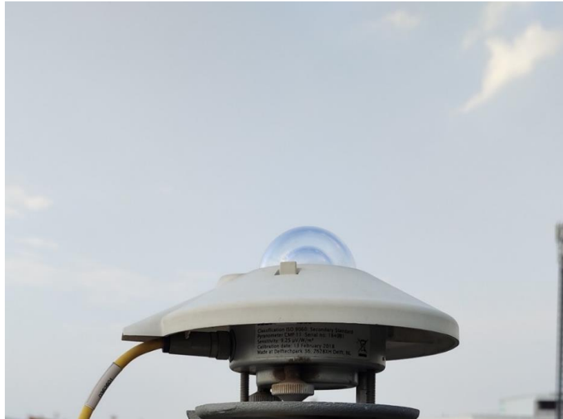
รูปที่ 45 เครื่องวัดรังสีรวมของ Kipp & Zonen รุ่น CMP11 ที่สถานีอุตุนิยมวิทยานครราชสีมา
