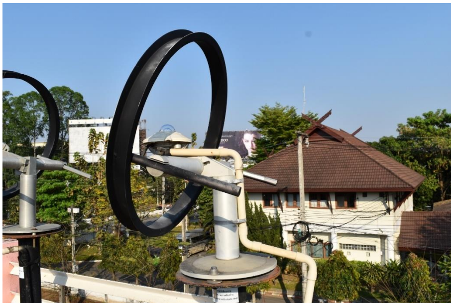
รูปที่ 49 เครื่องวัดรังสีกระจาย (เครื่องไพราโนมิเตอร์กับวงแหวนบังรังสีตรง ของ Kipp & Zonen รุ่น CM21) ที่สถานีศูนย์อุตุนิยมวิทยาภาคเหนือ จังหวัดเชียงใหม่
