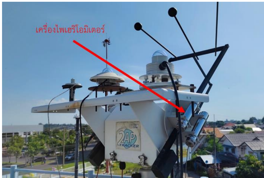
รูปที่ 54 เครื่องโฟเฮริโอมิเตอร์ ที่สถานีศูนย์อุตุนิยมวิทยาภาคตะวันออกเฉียงเหนือตอนล่าง จังหวัดอุบลราชธานี
