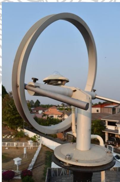
รูปที่ 50 เครื่องวัดรังสีกระจาย (เครื่องไพราโนมิเตอร์กับวงแหวนบังรังสีตรง ของ Kipp & Zonen รุ่น CM21) ที่สถานีศูนย์อุตุนิยมวิทยาภาคตะวันออกเฉียงเหนือตอนล่าง จังหวัดอุบลราชธานี
