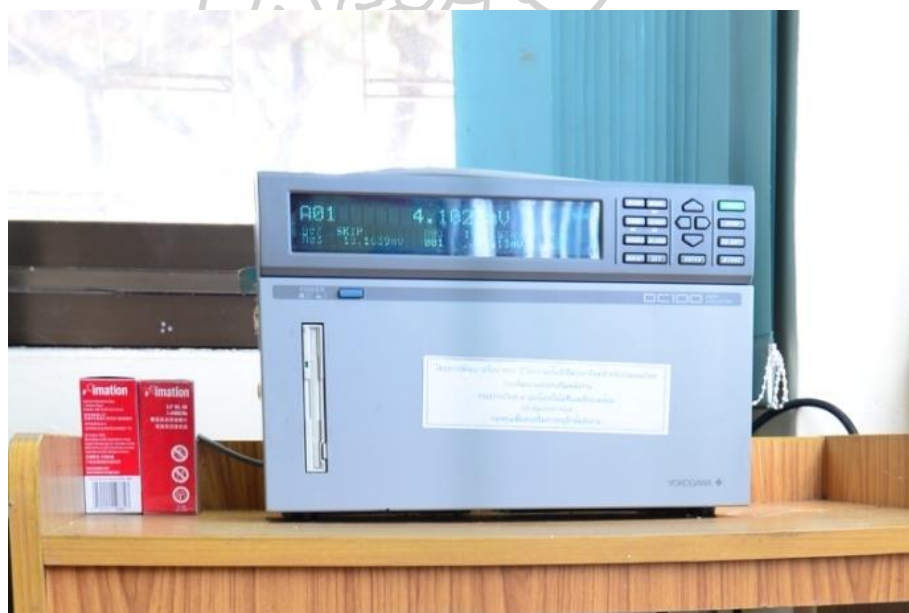
รูปที่ 44 เครื่องบันทึกข้อมูลของบริษัท Yokogawa รุ่น DC100 ที่สถานีลพบุรี
