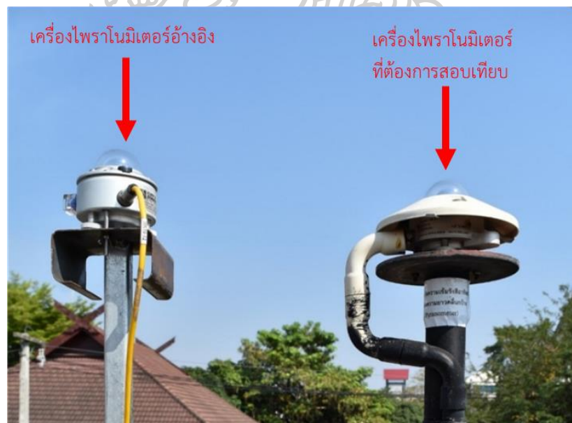
รูปที่ 65 ตัวอย่างการสอบเทียบเครื่องวัดรังสีรวม ที่สถานีศูนย์อุตุนิยมวิทยาภาคเหนือ จังหวัด เชียงใหม่
