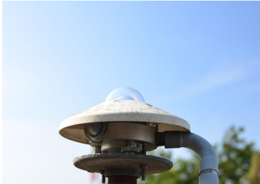
รูปที่ 43 เครื่องวัดรังสีรวมของ Kipp & Zonen รุ่น CMP11 ที่สถานีลพบุรี
