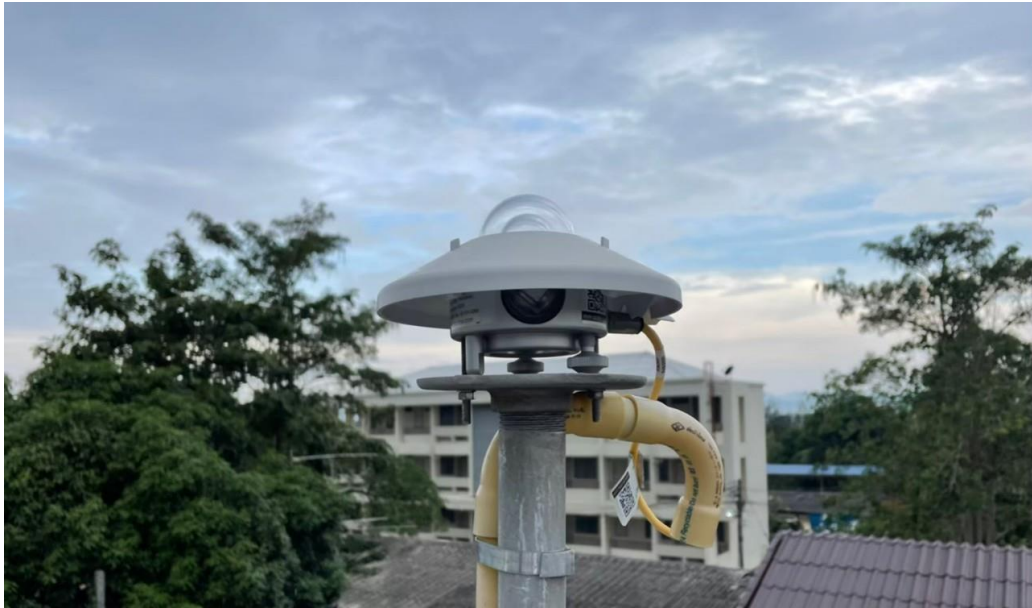
รูปที่ 47 เครื่องวัดรังสีรวมของ Kipp & Zonen รุ่น CMP11 ที่สถานีอุตุนิยมวิทยาประจวบคีรีขันธ์
