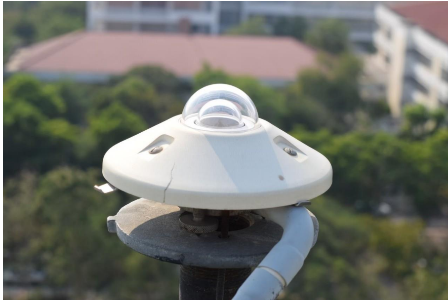
รูปที่ 35 เครื่องวัดรังสีรวมของ Kipp & Zonen รุ่น CMP11 ที่สถานีคณะวิทยาศาสตร์ มหาวิทยาลัยศิลปากร จังหวัดนครปฐม
