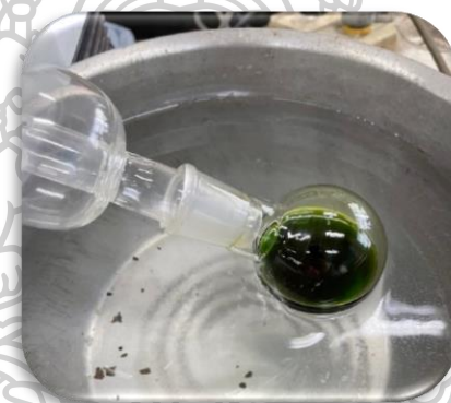
ภาพที่ 18 นำสารสกัดที่ได้ทำการระเหยเอาตัวทำละลายออกด้วยเครื่อง rotary evaporator
