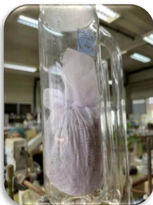
ภาพที่ 19 นำตัวอย่างกัญชาอัดแท่งมาห่อด้วยผ้าขาวบางมัดให้แน่น จากนั้นนำไปใส่ในเครื่อง soxhlet extraction
