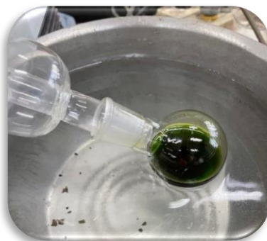
ภาพที่ 13 นำสารสกัดที่ได้ทำการระเหยเอาตัวทำละลายออกด้วยเครื่อง rotary evaporator
