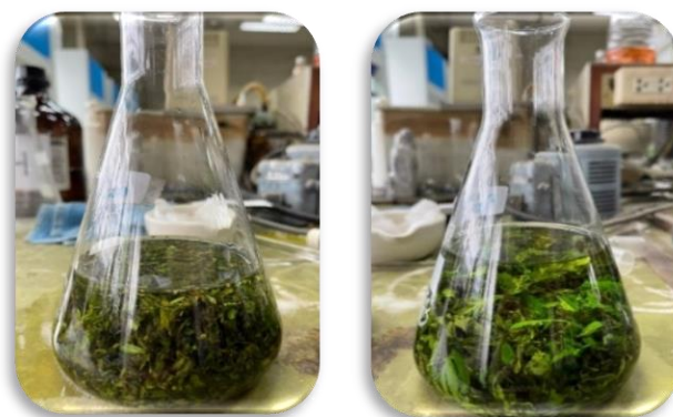
ภาพที่ 17 ส่วนดอกและใบของพืชกัญชา สกัดด้วยตัวทำละลายเอทานอล ในปริมาณ 400 mL
