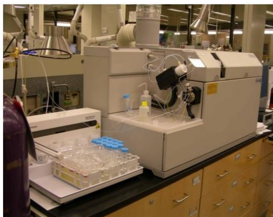
ภาพที่ 7 เครื่องวิเคราะห์หาปริมาณธาตุโดยการตรวจวัดมวลของไอออนของธาตุ
