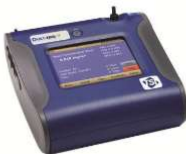
รูปที่ 3.2 เครื่องวัดปริมาณฝุ่น Dusttrak™ II Aerosol Monitor Model 8530 ที่มา: TSI (2015)
