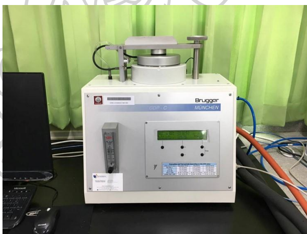
รูปที่ 3.6 เครื่องวัดอัตราการซึมผ่านของก๊าซบนแผ่นฟิล์ม (Gas Permeability Tester, Brugger GDP-C)
