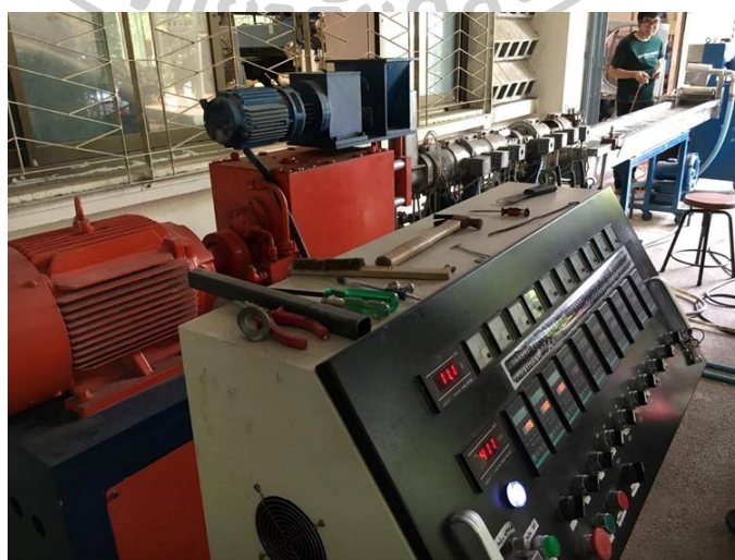
รูปที่ 3. 1 เครื่องอัดรีดแบบสกรูคู่ (Twin screw extruder)
