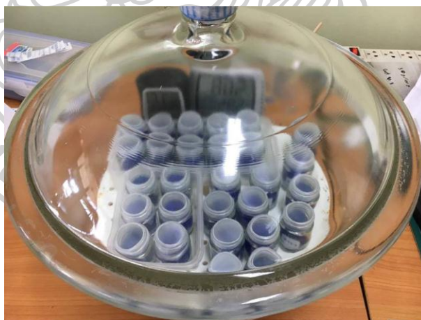
รูปที่ 3.7 การวัดอัตราการซึมของไอน้ำของฟิล์ม (WTVR)
