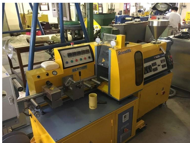
รูปที่ 3. 2 เครื่องอัดรีดฟิล์มบาง (Cast Film Extruder)
