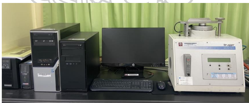
รูปที่ 3.8 เครื่องทดสอบอัตราการซึมผ่านของออกซิเจน (Oxygen transmission rate, OTR)
