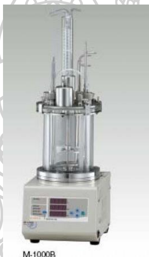
ภาพที่ 11 ถังปฏิกรณ์ชีวภาพแบบถังกวน (stirred tank) รุ่น EYELA [37]
