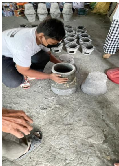
คุณตาทรี ปราชญ์ชาวบ้านแนะนำการปั้นเตาและการเจาะช่องอากาศของเตา
