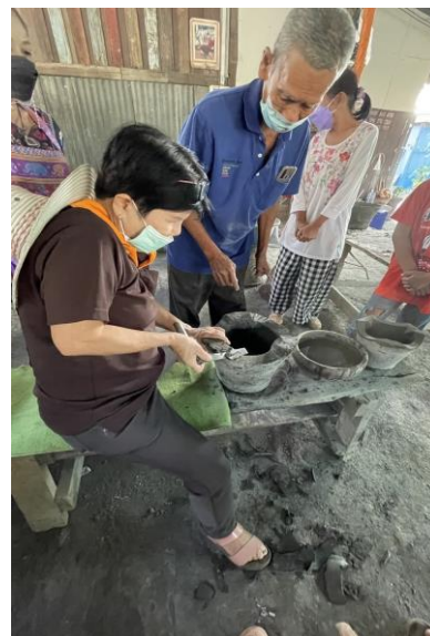
คุณตาทรี ปราชญ์ชาวบ้านแนะนำการปั้นเตาและการเจาะช่องอากาศของเตา
