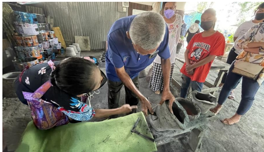
คุณตาทรี ปราชญ์ชาวบ้านแนะนำการปั้นเตาและการเจาะช่องอากาศของเตา
