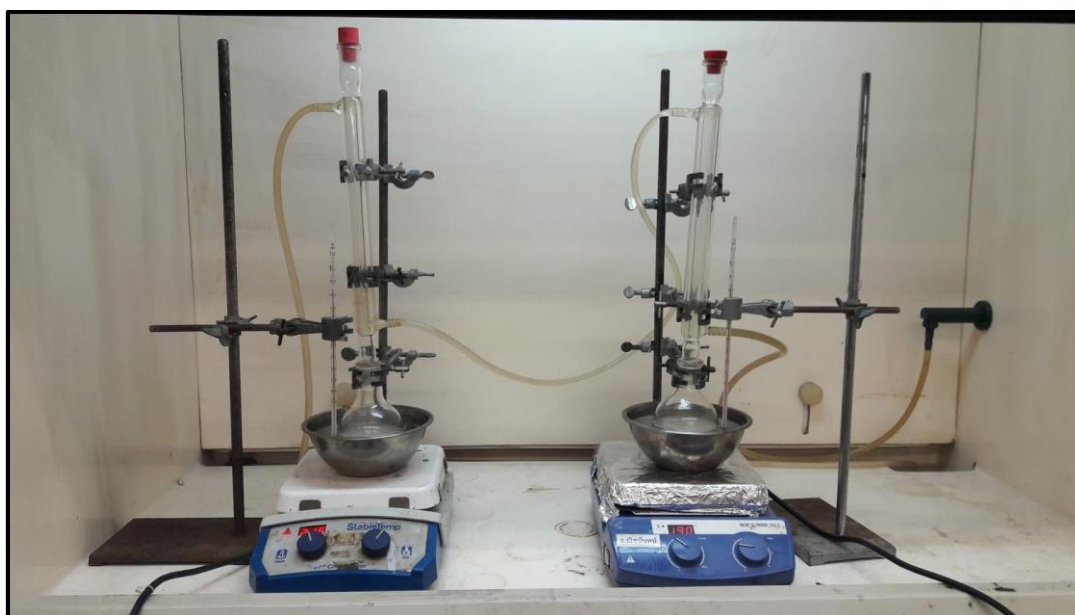
รูปที่ 3.5 ชุดอุปกรณ์รีฟลักซ์เพื่อหาปริมาณลิกพิด
