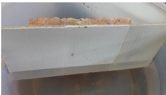
รูปที่ 5 ชั้นรองพื้นที่มีสถานะแข็งในน้ำ (น้ำตามบ้านเรือน)
