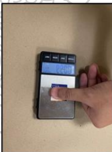
ภาพที่ 39 การประทับรอยลายนิ้วมือลงบนตัวอย่างใช้แรงกดประมาณ 750-800 g. เป็นเวลา 10 s.
