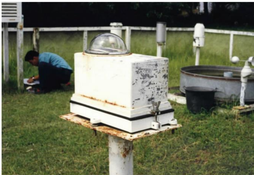
รูปที่ 8 เครื่องวัดรังสีรวมแบบโรบิตซ์ของกรมพัฒนาและส่งเสริมพลังงาน
