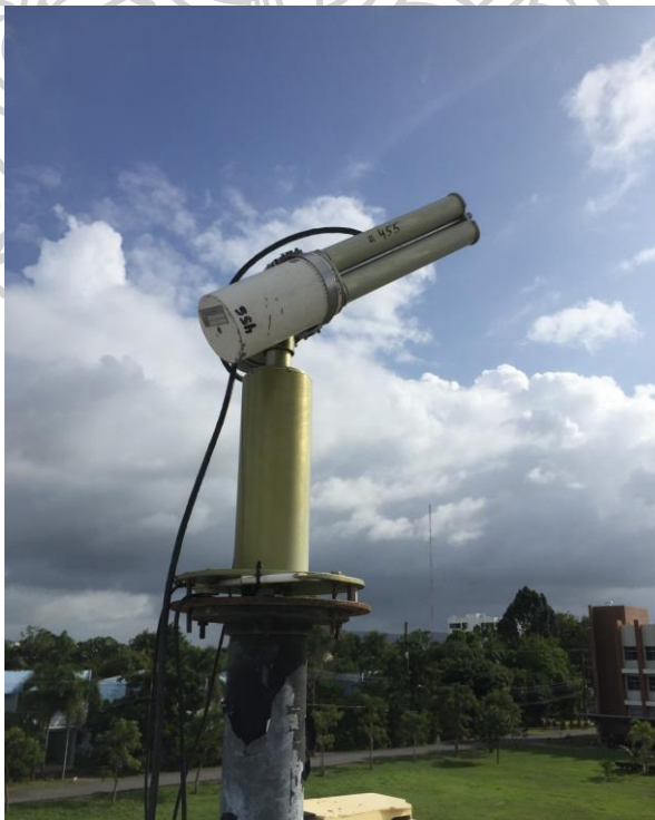
รูปที่ 25 เครื่องชั้นโฟโตมิเตอร์ ซึ่งติดตั้งอยู่ที่ศูนย์อู่ศูนย์มหาวิทยาลัยภาคใต้ฝั่งตะวันออก จังหวัดสงขลา
