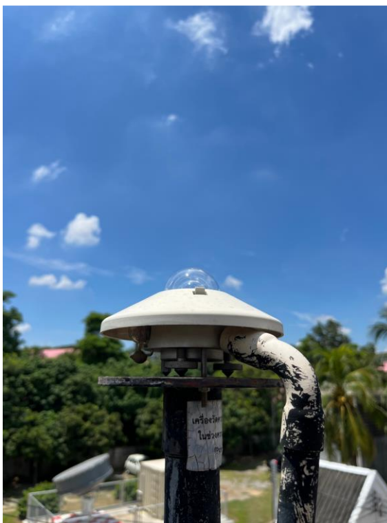
รูปที่ 14 เครื่องไพราโนมิเตอร์ รุ่น CM21 บริษัท Kipp&Zonen ของสถานีเชียงใหม่
