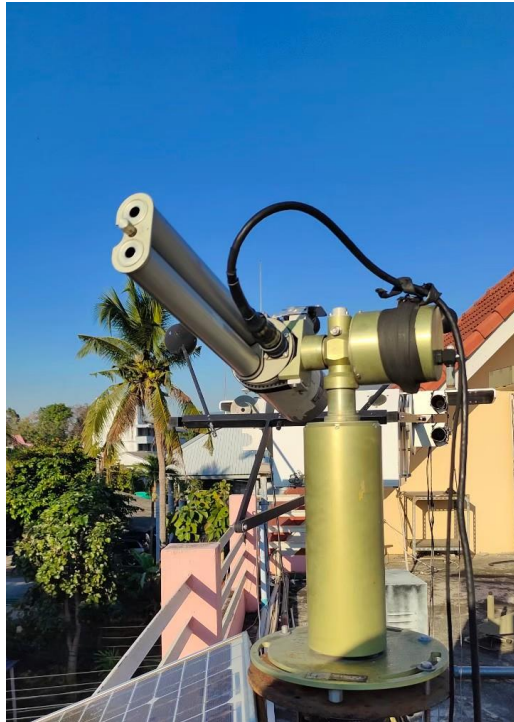
รูปที่ 22 เครื่องซันโฟโตมิเตอร์ ซึ่งติดตั้งอยู่ที่ศูนย์อุตุนิยมวิทยาภาคเหนือ จังหวัดเชียงใหม่
