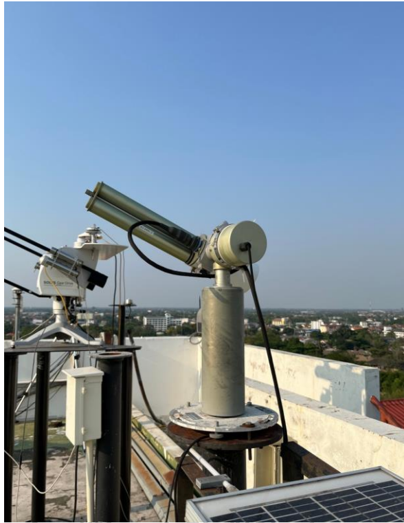
รูปที่ 24 เครื่องชั้นโฟโตมิเตอร์ ซึ่งติดตั้งอยู่ที่คณะวิทยาศาสตร์ มหาวิทยาลัยศิลปากร จังหวัดนครปฐม
