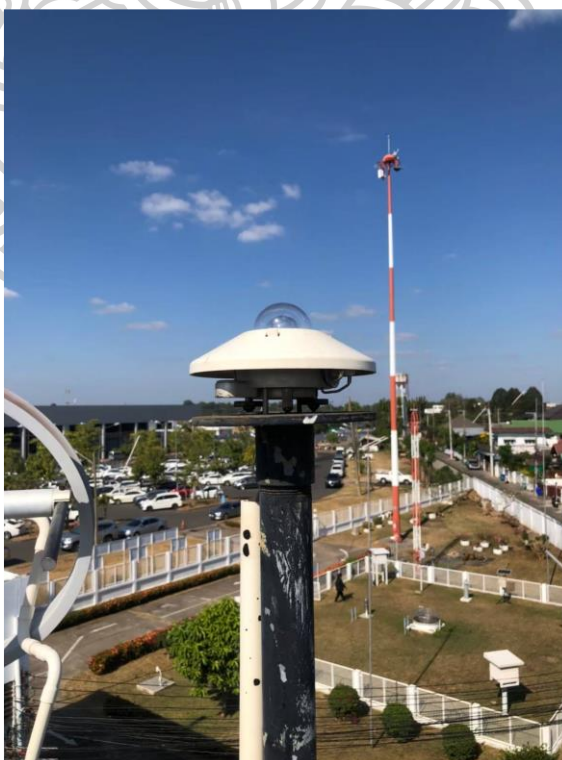
รูปที่ 15 เครื่องไพราโนมิเตอร์ รุ่น CM11 บริษัท Kipp&Zonen ของสถานีอุบลราชธานี
