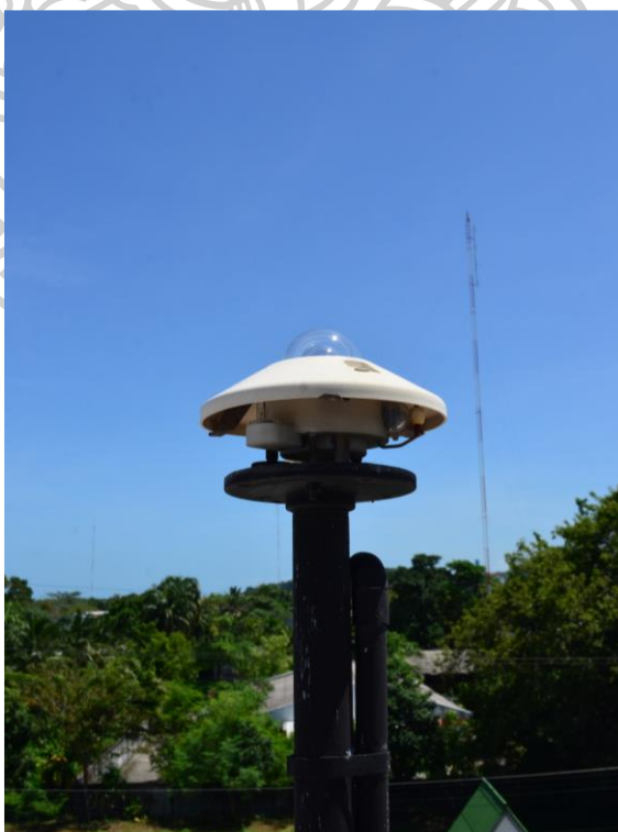
รูปที่ 17 เครื่องไพราโนมิเตอร์ รุ่น CM21 บริษัท Kipp&Zonen ของสถานีสงขลา
