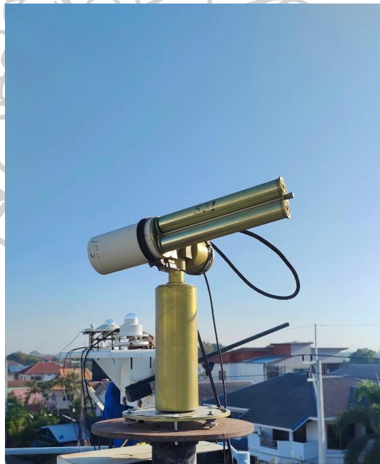
รูปที่ 23 เครื่องซันโฟโตมิเตอร์ ซึ่งติดตั้งอยู่ที่ศูนย์อุตุนิยมวิทยาภาคตะวันออกเฉียงเหนือตอนล่าง จังหวัดอุบลราชธานี
