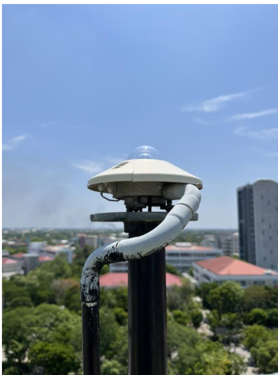
รูปที่ 16 เครื่องไพราโนมิเตอร์ รุ่น CM21 บริษัท Kipp&Zonen ของสถานีนครปฐม
