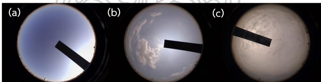
รูปที่ 28 ตัวอย่างภาพถ่ายท้องฟ้าที่ได้จากเครื่องถ่ายภาพท้องฟ้า กรณีวันที่ (a) ท้องฟ้าปราศจากเมฆ (clear sky) (b) ท้องฟ้ามีเมฆบางส่วน (partly sky) และ (c) ท้องฟ้าปกคลุมด้วยเมฆทั้งหมด (overcast sky)
