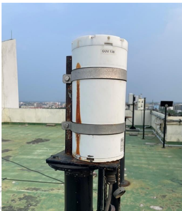
รูปที่ 20 เครื่องวัดความเข้มรังสีอัลตราไวโอเล็ตแบบใช้แผ่นกรองรังสีหลายช่องสัญญาณรุ่น GUV-2511 ผลิตโดยบริษัท Biospherical Instruments Inc.
