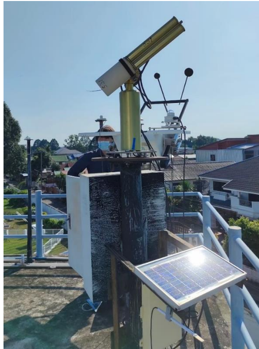
รูปที่ 32 เครื่องชั้นโฟโตมิเตอร์ที่ติดตั้งอยู่ที่ศูนย์อุตุนิยมวิทยาภาคตะวันออกเฉียงเหนือตอนล่าง จังหวัดอุบลราชธานี
