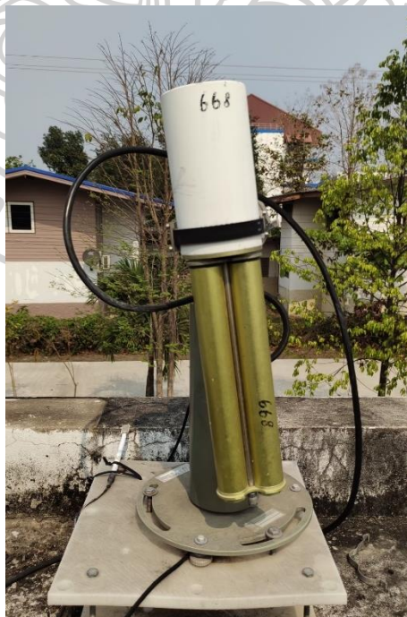
รูปที่ 35 เครื่องชั้นโฟโตมิเตอร์ที่ติดตั้งอยู่ที่สวนอุทกวิทยาหนองคาย จังหวัดหนองคาย
