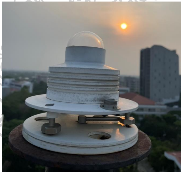
รูปที่ 19 เครื่องวัดรังสีอัลตราไวโอเล็ตที่มีผลต่อผิวหนังมนุษย์รุ่น 501A ที่ผลิตโดยบริษัท Solar Light
