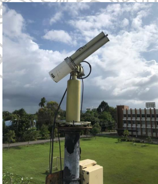
รูปที่ 33 เครื่องชั้นโฟโตมิเตอร์ที่ติดตั้งอยู่ที่ศูนย์อุตุนิยมวิทยาภาคใต้ฝั่งตะวันออก จังหวัดสงขลา
