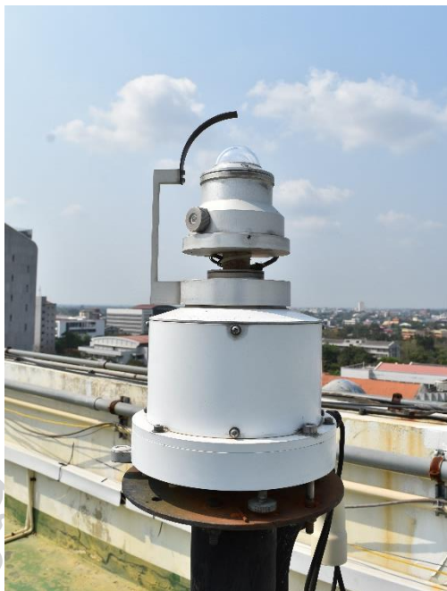
รูปที่ 27 เครื่องถ่ายภาพท้องฟ้าที่ติดตั้งอยู่ที่ตาดฟ้าอาคารวิทยาศาสตร์ 1 คณะวิทยาศาสตร์ มหาวิทยาลัยศิลปากร จังหวัดนครปฐม
