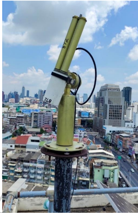
รูปที่ 34 เครื่องชั้นโฟโตมิเตอร์ที่ติดตั้งอยู่ที่กรมพัฒนาพลังงานทดแทนและอนุรักษ์พลังงาน กรุงเทพมหานคร
