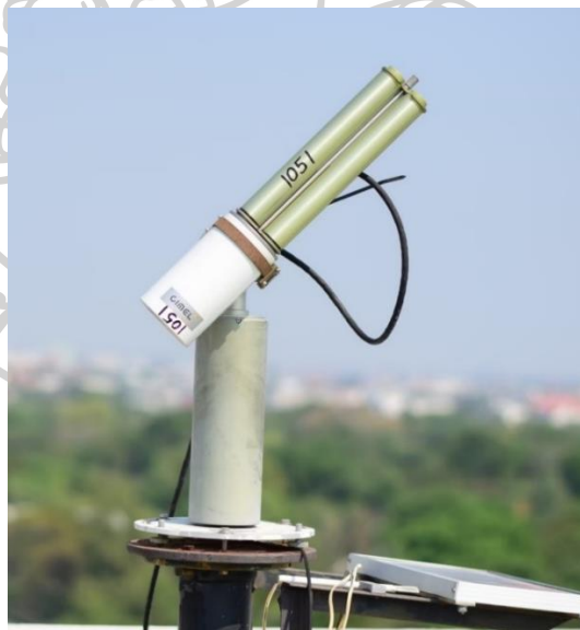
รูปที่ 31 เครื่องชันโฟโตมิเตอร์ที่ติดตั้งอยู่ที่มหาวิทยาลัยศิลปากร จังหวัดนครปฐม
