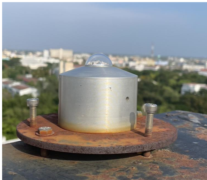
รูปที่ 22 ตัวรับรังสี (input optics) ของเครื่องวัดสเปกตรัมรังสีอัลตราไวโอเล็ตจากดวงอาทิตย์ที่ติดตั้งบนตาดฟ้าอาคารวิทยาศาสตร์ 1 มหาวิทยาลัยศิลปากร
