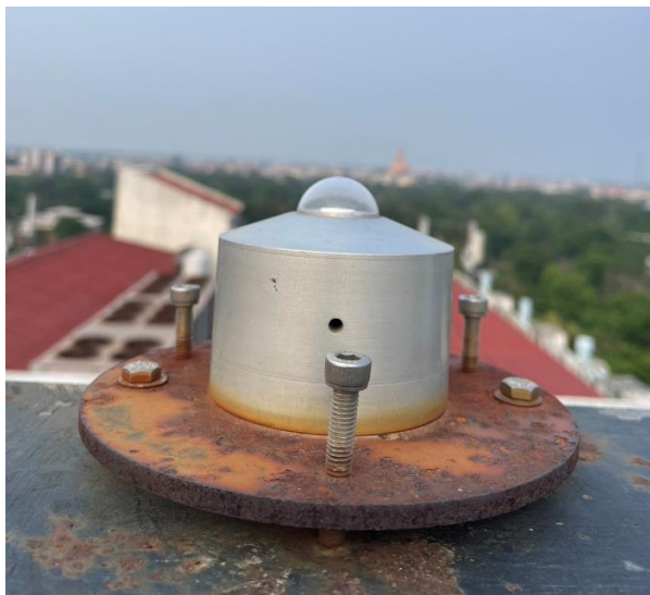
รูปที่ 17 ตัวรับรังสีของเครื่องวัดสเปกตรัมรังสีอัลตราไวโอเล็ต (input optics) รุ่น DMc150 ผลิตโดย บริษัท Bentham Instruments Ltd.
