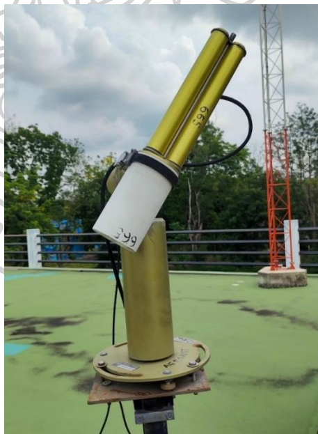
รูปที่ 36 เครื่องชั้นโฟโตมิเตอร์ที่ติดตั้งอยู่ที่สถานีอุตุนิยมวิทยาสระแก้ว (อรัญประเทศ) จังหวัดสระแก้ว
