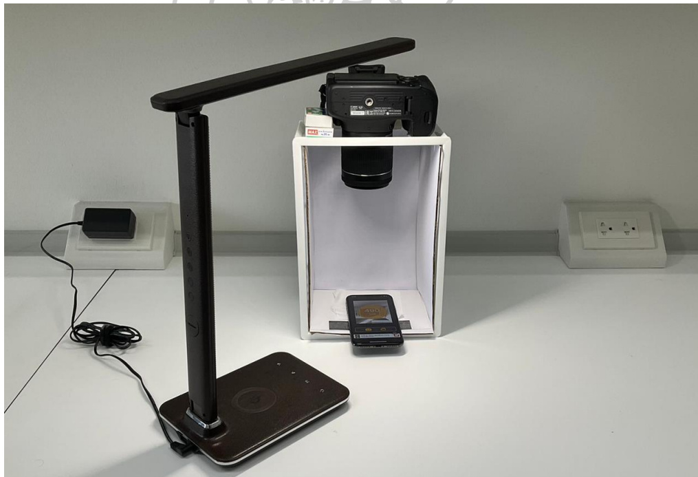
ภาพที่ 29 การวัดค่าแสงด้วยแอปพลิเคชันบริเวณจุดวางผ้าตัวอย่าง
