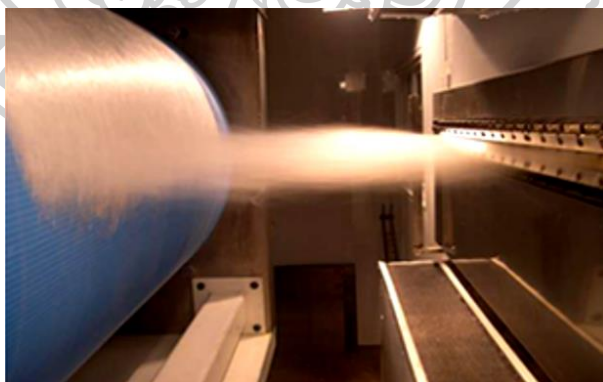
รูปที่ 5 กระบวนการผลิตเส้นใย Melt blowing
