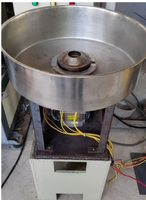
รูปที่ 22 โครงสร้างของเครื่อง RJS ที่ปรับปรุงใหม่ และช่องว่างระหว่าง Collector และหัวปั่นที่ลดลง
