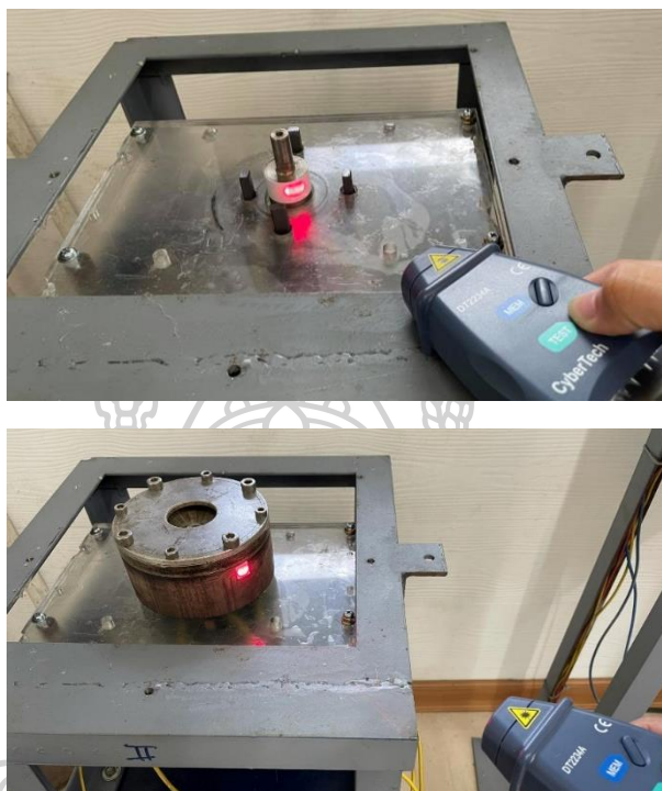
รูปที่ 36 ตำแหน่งสำหรับทดสอบวัดความเร็วรอบของยูนิเวอร์แซลมอเตอร์ แบบไม่ติดตั้งหัวปั่น (บน) แบบติดตั้งหัวปั่น (ล่าง)
