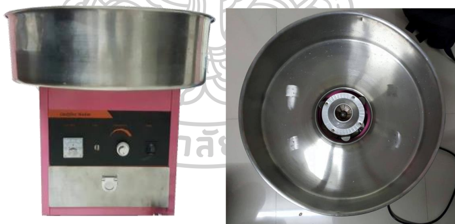
รูปที่ 10 เครื่องปั่นสายไหมที่เป็นเครื่องต้นแบบของเครื่อง Rotational jet spinning (RJS)
