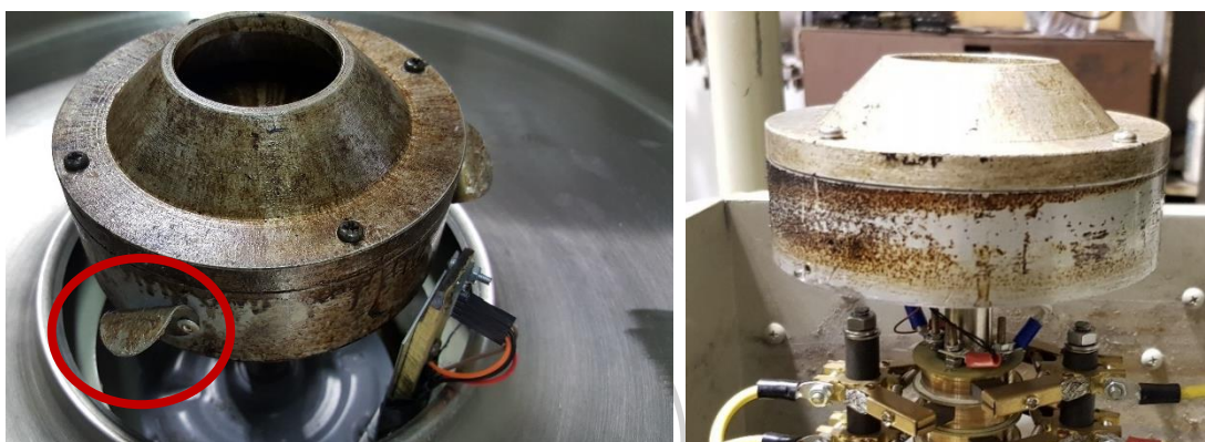
รูปที่ 16 ไบพัดที่ติดตั้งอยู่กับหัวปั่นก่อนถูกนำออกไป (วงกลมสีแดง) ด้านซ้าย และหลังจากนำไบพัดออกไป ด้านขวา
