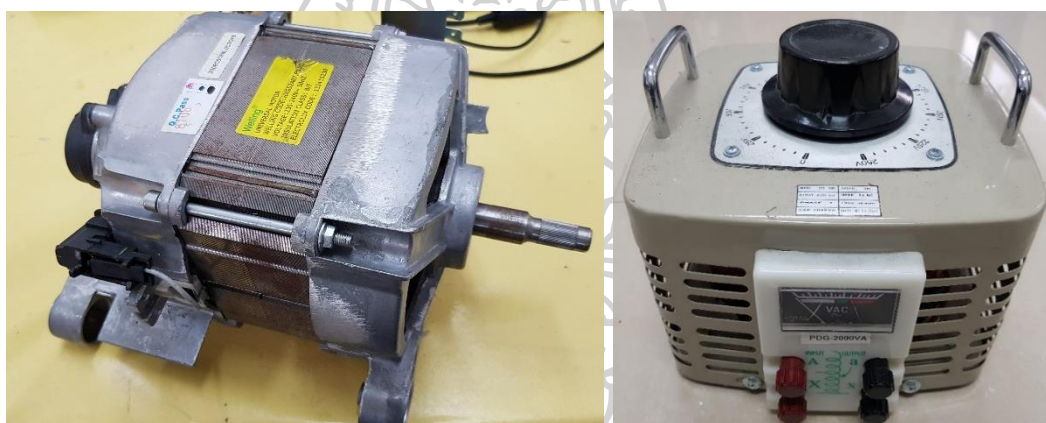
รูปที่ 13 ยูนิเวอร์แซลมอเตอร์ (ซ้าย) และ Voltage regulator (ขวา) สำหรับควบคุมความเร็วรอบ
