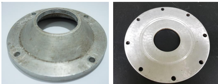
รูปที่ 20 ฝาปิดก่อนปรับปรุง (ซ้าย) และหลังปรับปรุง (ขวา)
