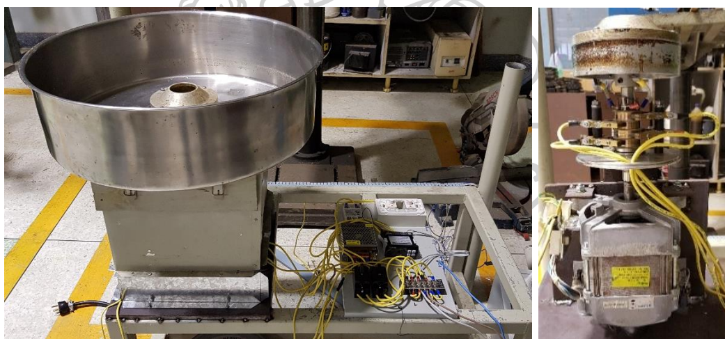
รูปที่ 17 เครื่อง RJS เวอร์ชันที่สอง (ซ้าย) และหัวปั่น Slip ring และมอเตอร์ ที่ประกอบเข้าด้วยกัน (ซ้าย)
