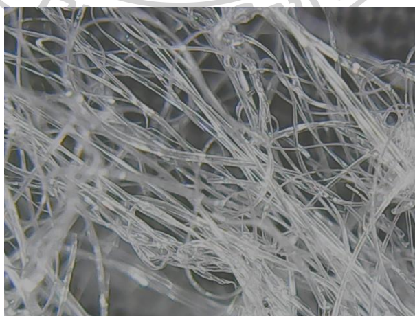
รูปที่ 12 เส้นใยพอลิแลกติกแอซิดเกรด Synthesis PLA ที่ปั่นด้วยเครื่อง RJS เวอร์ชันที่หนึ่งด้วยสภาวะ 1800 rpm อุณหภูมิ 250 °C
