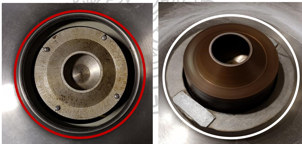
รูปที่ 19 ช่องว่างระหว่างหัวปั่นและฝาปิด วงกลมสีแดง(ภาพซ้าย) และติดตั้งแผ่นวงแหวนเพื่อปิดช่องว่างดังกล่าว วงกลมสีขาว(ภาพขวา)
