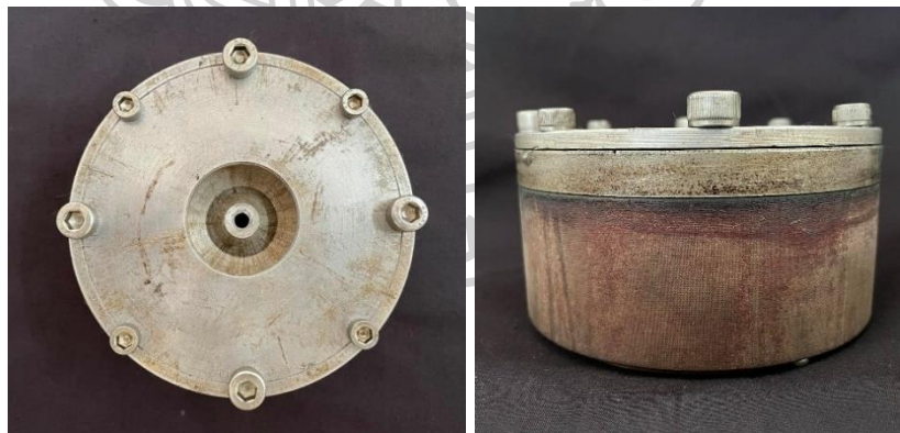
รูปที่ 32 หัวปั่น (Spinneret) และฝาปิดหลังปรับปรุง Top view (ซ้าย) Side view (ขวา)
