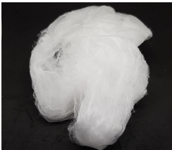
รูปที่ 18 เส้นใยพอลิแลกติกแอซิดเกรด 3052D ที่สภาวะ 1800 rpm อุณหภูมิ 190 °C
