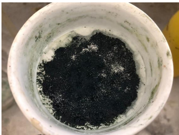
รูปที่ 4.1 วัสดุคอมพอสิต PANI-Ag ที่สังเคราะห์ผ่านกระบวนการพอลิเมอไรเซชันระหว่างผิวที่รอยต่อ
