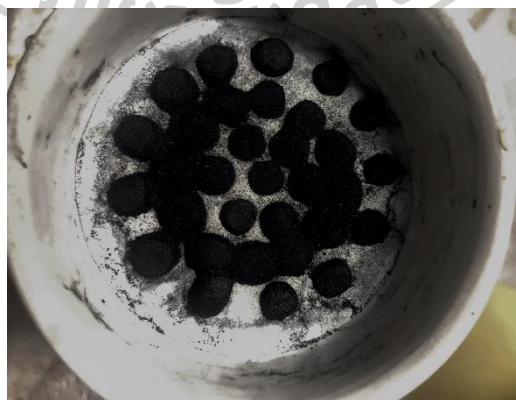
รูปที่ 4.22 วัสดุคอมพอสิตสามองค์ประกอบ PANI-NiO 2 .0-RGO ที่สังเคราะห์ผ่านกระบวนการพอลิเมอไรเซชันระหว่างผิวที่รอยต่อ
