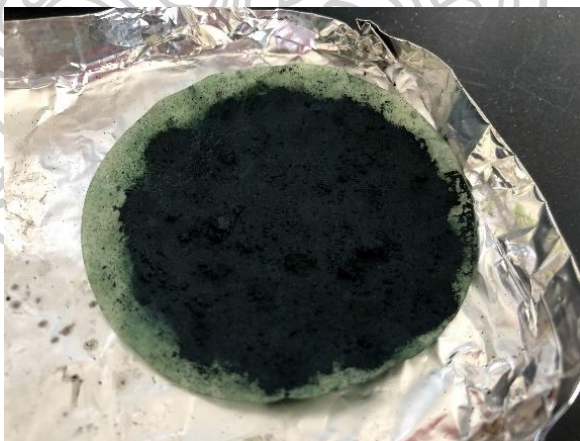
รูปที่ 4.11 วัสดุคอมพอสิต PANI-NiO ที่สังเคราะห์ผ่านกระบวนการพอลิเมอไรเซชันระหว่างผิวที่รอยต่อ
