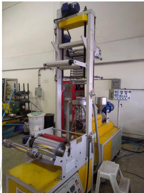
รูปที่ 3.14 เครื่อง blown film extrusion รุ่น TB El 20/Bi จากบริษัท Thai plastic bag industries Co., LTD
