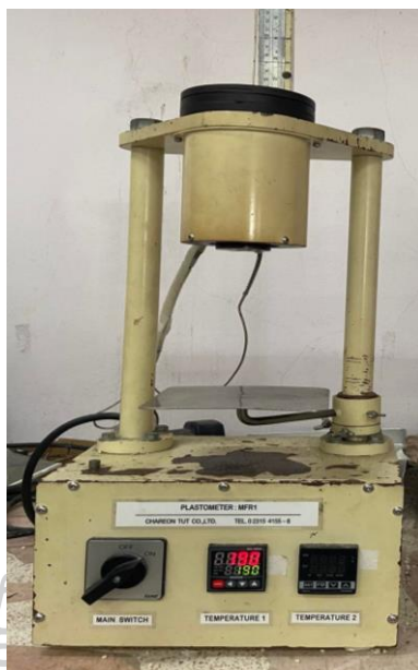
รูปที่ 3.13 เครื่อง Melt Flow Indexer รุ่น Plastometer: MFR1 จากบริษัทเจริญทัศน์
