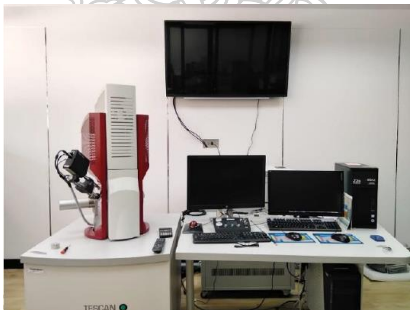
รูปที่ 3.11 เครื่อง Field Emission Scanning Electron Microscope, FESEM รุ่น MIRA3 จากบริษัท TESCAN
