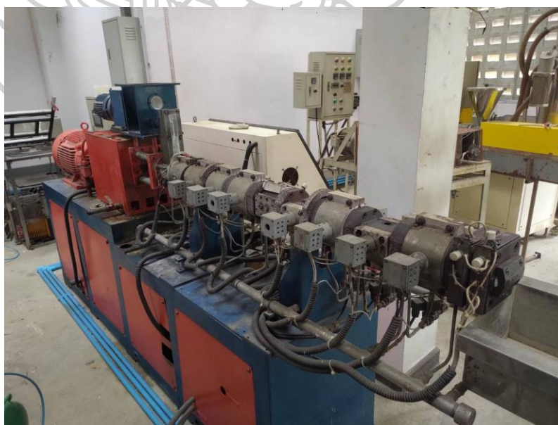
รูปที่ 3.12 เครื่องอัดรีบแบบสกรูคู่ twin-screw extrusion รุ่น HRJ-25 จากบริษัท Enmach Co.,
