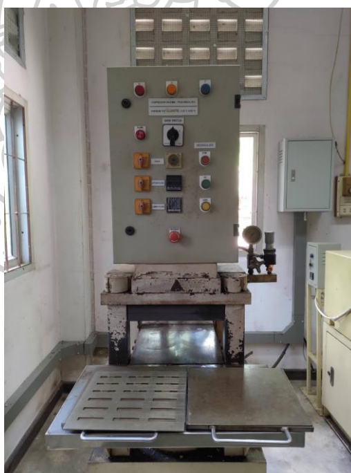
รูปที่ 3.9 เครื่อง Compression molding) รุ่น PR10-W300L350 จากบริษัทเจริญทัศน์
