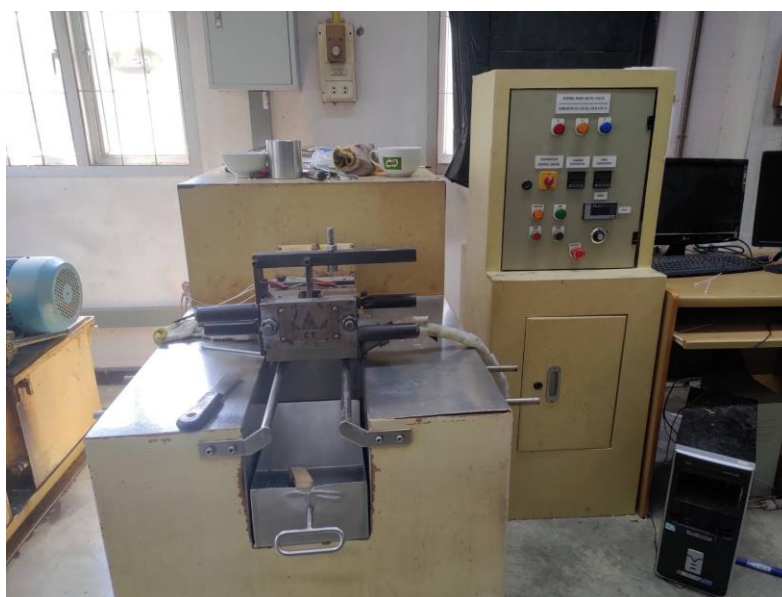
รูปที่ 3.8 เครื่อง internal mixer รุ่น MX 105-D40L50 จากบริษัทเจริญทัศน์
