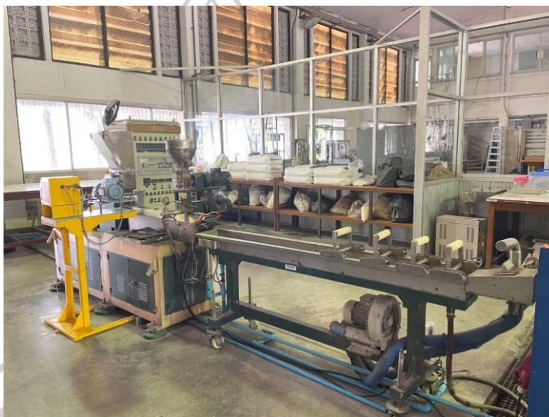
ภาพที่ 23 เครื่องอัดรีดแบบสกรูคู่ (Twin-screw extruder)
