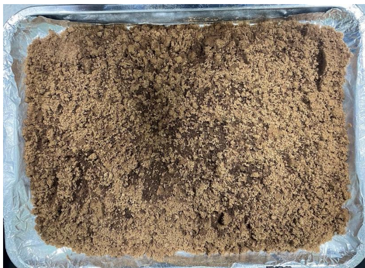
ภาพที่ 22 แสดงผงซีลี้อยไม้สักที่พรมให้เปียกด้วยสารละลายไซเลน
