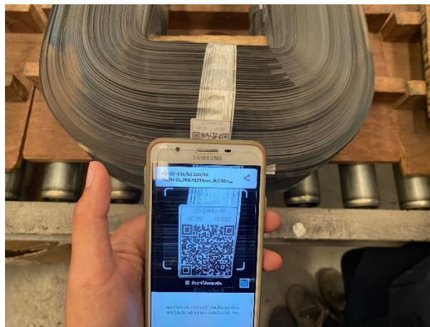
Figure 34 ทดลองสแกนอ่านรหัส สติกเกอร์ FG QR Code Tag
