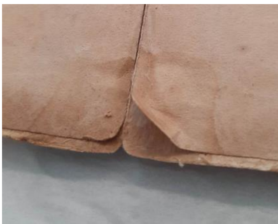
ภาพที่ 45 ผลการทดสอบการละลายของกาว สามารถละลายออกได้ง่าย
