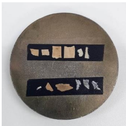
ภาพที่ 50 ตัวอย่างที่นำไปวิเคราะห์ด้วยเครื่อง SEM-EDS
