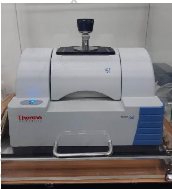
ภาพที่ 3 เครื่อง FTIR ยี่ห้อ Thermo Scientific รุ่น NICOLET iS5-iD7 (ATR)
