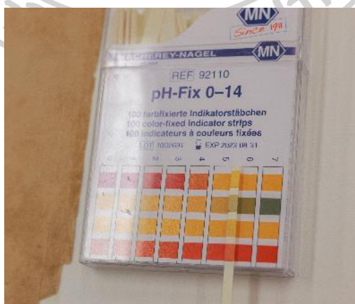
ภาพที่ 35 ผลทดสอบกระดาษรองรับภาพ ตัวอย่าง A010 ได้ค่า pH ประมาณ 5-5.5
