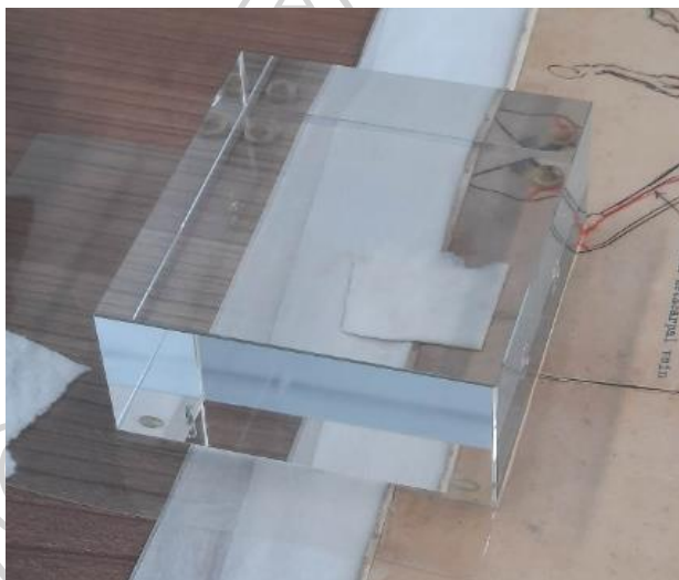
ภาพที่ 44 ทดสอบการละลายของกาวด้วยการให้ความชื้น
