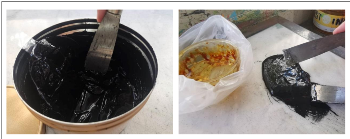
ภาพที่ 28 การใช้เกรียงปาดหมึกจากกระป๋อง และการผสมหมึกด้วยคอมปาวจ์
