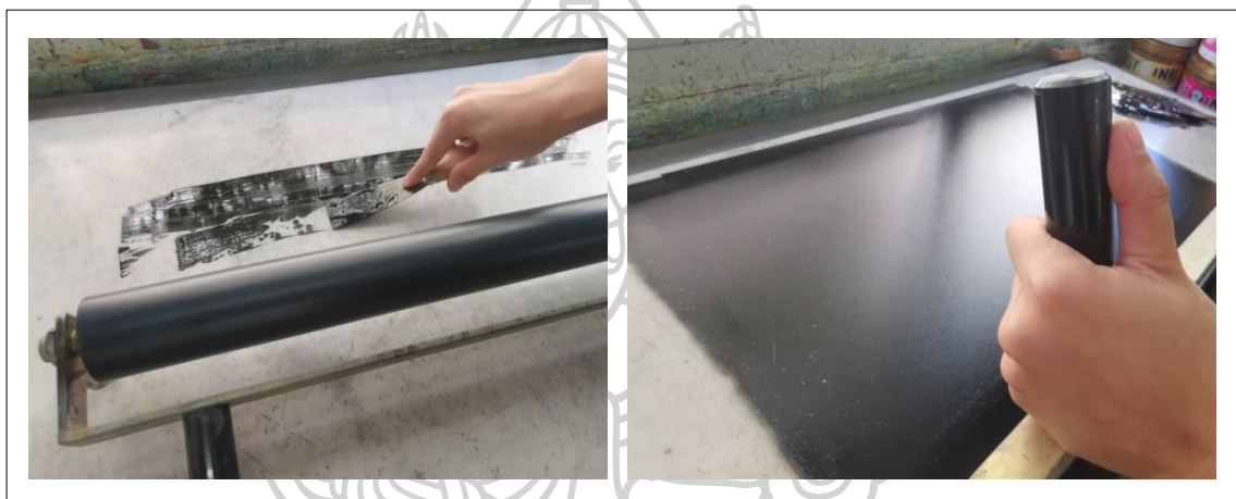
ภาพที่ 29 การใช้เกรียงปาดหมึก และการใช้ลูกกลิ้งกลิ้งหมึกบนโต๊ะหินอ่อน
