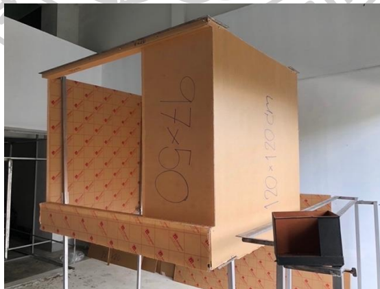
ภาพที่ 90 การทดลองประกอบแผ่นอะคริลิกเข้ากับโครงสร้างเหล็กขนาดเท่าทางเดินขึ้นเจดีย์ของจริง ที่มา: ภาพถ่ายประกอบเนื้อหาบันทึกภาพโดยผู้สร้างสรรค์
