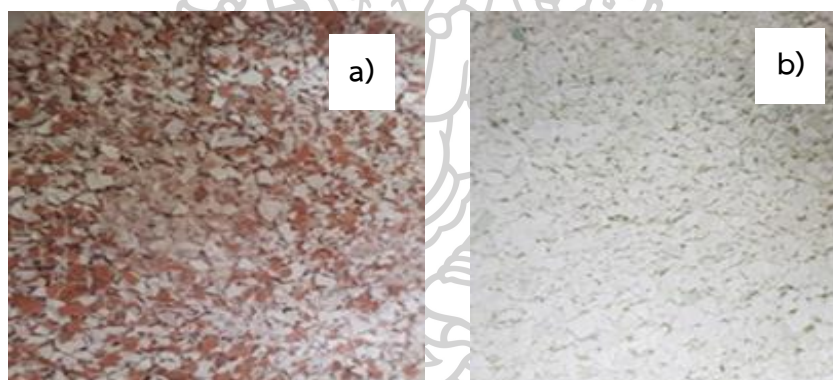
ภาพที่ 25 ผงปูนไฮ (a) ก่อนเผา (b) หลังเผาที่อุณหภูมิ 550°C เป็นเวลา 49 ชั่วโมง
