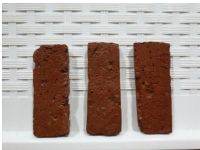
นำอิฐไปแช่น้ำก่อนฉาบปูนแต่ละอัตราส่วน
