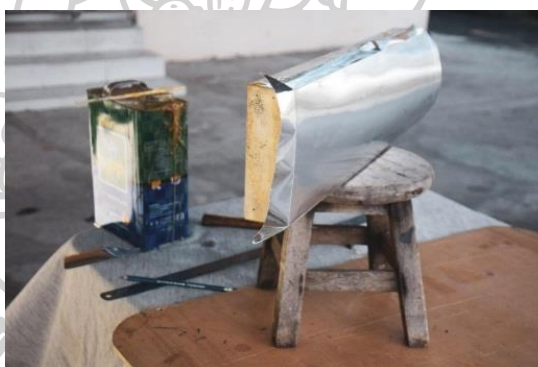
ภาพที่ 83: ขั้นตอนที่ 4 ทากาวยางทั้งสองด้านก่อนห่อด้วยแผ่นอะลูมิเนียม ที่มา: รูปถ่ายส่วนตัว
