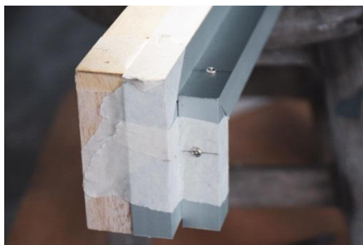
ภาพที่ 84: ขั้นตอนที่ 5 การวางค้ำขอบมุกฉากอลูมิเนียมก่อนยึดด้วยน็อต ที่มา: รูปถ่ายส่วนตัว
