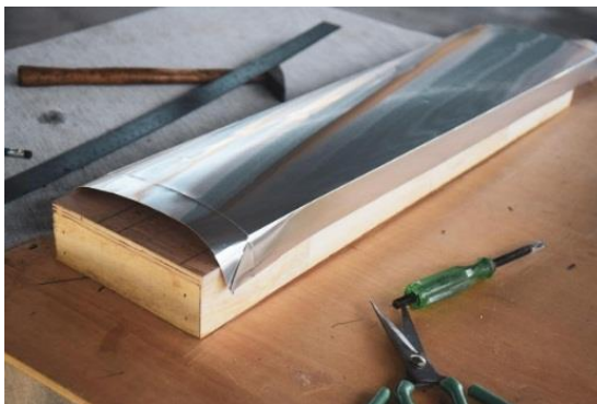
ภาพที่ 82: ขั้นตอนที่ 3 พับแผ่นอะลูมิเนียมวางเทียบขนาด ที่มา: รูปถ่ายส่วนตัว
