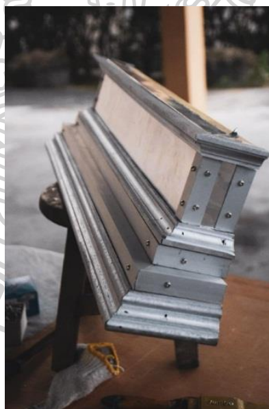
ภาพที่ 87: ขั้นตอนที่ 8 การสร้างผลงานด้วยค้ำมุมฉากและท่ออลูมิเนียมพร้อมยึดน็อต ที่มา: รูปถ่ายส่วนตัว
