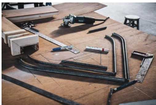
ภาพที่ 103: ภาพขั้นตอนเตรียมโครงสร้างเหล็กส่วนบน ที่มา: รูปถ่ายส่วนตัว
