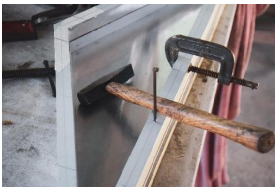
ภาพที่ 86: ขั้นตอนที่ 7 ยึดค้ำมุมฉากอลูมิเนียมด้วยน็อต ที่มา: รูปถ่ายส่วนตัว
