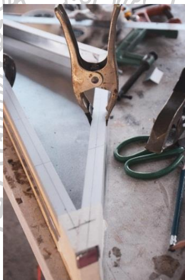
ภาพที่ 85: ขั้นตอนที่ 6 ยึดค้ำมุกฉากอลูมิเนียมด้วยน็อต ที่มา: รูปถ่ายส่วนตัว
