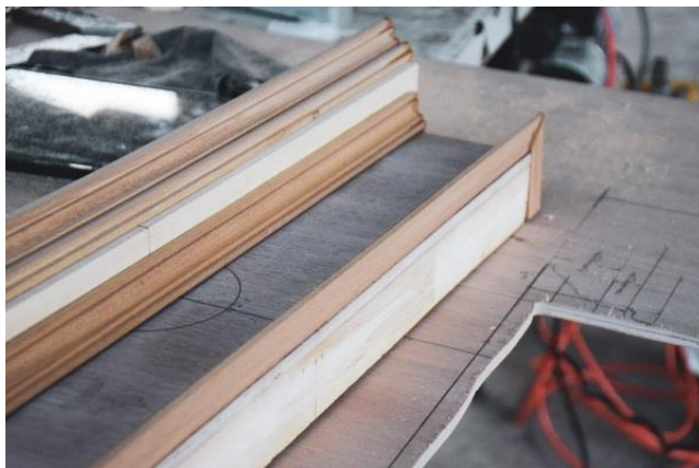
ภาพที่ 79: ขั้นตอนการสร้างผลงานไม้ด้านในก่อนห่อด้วยแผ่นอะลูมิเนียม
