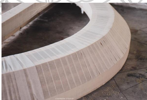
ภาพที่ 27: การพันเทปกระดาษก่อนวางใยแก้ว(ไฟเบอร์กลาส)
