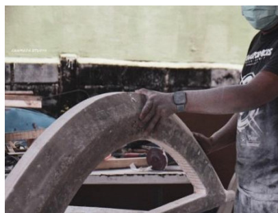
ภาพที่ 29: ขั้นตอนการขัดใยแก้ว(ไฟเบอร์กลาส)รอบแรก
