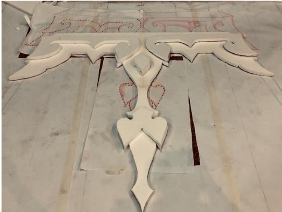
ภาพที่ 73 แบบหุ่นโฝมขนาด 1:1 ต้นแบบส่วนประดับเรือนธาตุที่สร้างขึ้นใหม่ (ส่วนบัวคอเสื้อ) ที่มา:ภาพถ่ายโดย พระทรงวิทย์ แจ้งจิตร เมื่อ พ.ศ.2562
