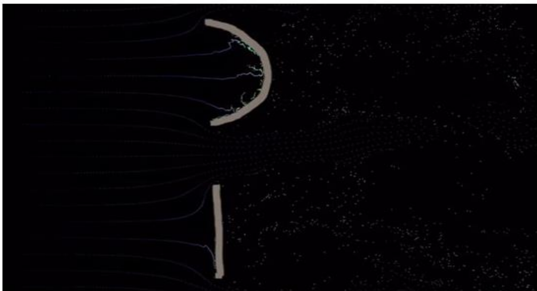
ภาพที่ 92 แสดงภาพการทดลองในโปรแกรมจำลองในคอมพิวเตอร์ สรุปได้ว่าทรงโค้ง มีส่วนช่วยในการดักมวลทรายอย่างมีประสิทธิภาพ (จากการศึกษาของผู้วิจัย)
