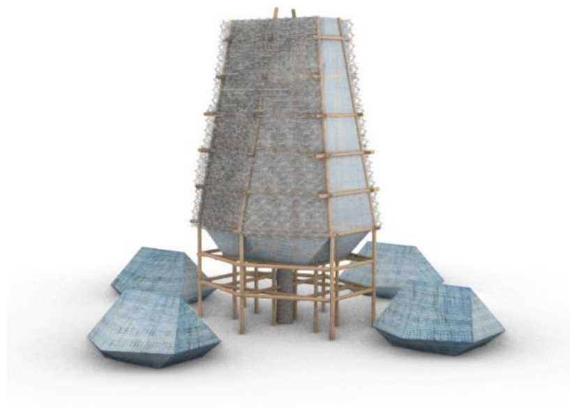
ภาพที่ 60 แสดงระบบโครงสร้างที่ง่ายต่อการก่อสร้างของคนในท้องถิ่น โดยวัสดุนั้นคือไม้ไผ่ซึ่งพบได้มากในท้องถิ่น (จากการศึกษาของผู้วิจัย)
