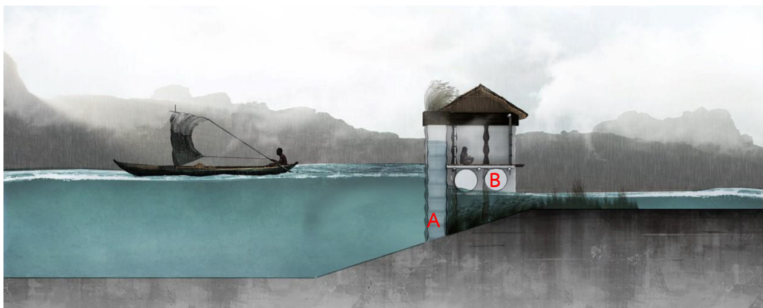
ภาพที่ 138 แสดงรูปตัดของหน่วยที่อยู่อาศัยและการทำงานของหน่วยกันแรงน้ำและลม ซึ่งแสดงให้เห็นการป้องกันแรงน้ำที่ไหลอย่างฉับพลัน (จากการศึกษาของผู้วิจัย)
