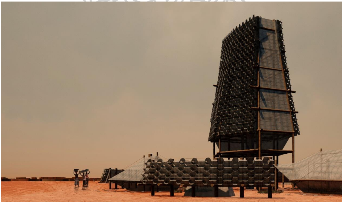
ภาพที่ 72 แสดงทัศนียภาพในบริเวณกลุ่มอาคาร สังเกตได้ว่าในบริเวณชั้นนอกของกลุ่มอาคารมีการติดตั้งแผงดักจับน้ำจากอากาศเพิ่มเติมเพื่อเพิ่ม ประสิทธิภาพในการผลิตน้ำและความชื้น (จากการศึกษาของผู้วิจัย)
