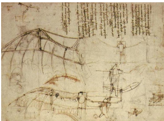
ภาพที่ 1 แสดงการออกแบบ ของเลโอนาร์โด ดา วินชีสำหรับเครื่องบินที่มีปีกอิงตามโครงสร้างของปีกค้างคาว
