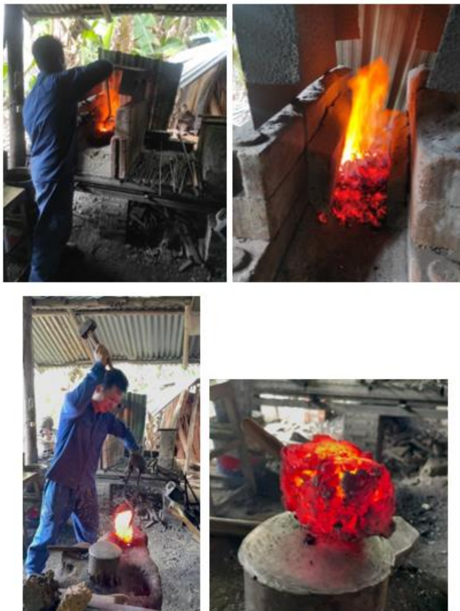
ภาพที่ 99 การนำก้อนเหล็กแข็งหรือกิ่งของแข็งมีตะกรันปะปน (Bloom) ที่ได้จากการถลุงเหล็กของเตาถลุง (BNT OPERATION01/2022) น้ำหนักรวม 11 กิโลกรัม มาตีกำจัดมลทินในเตาตีเหล็ก
