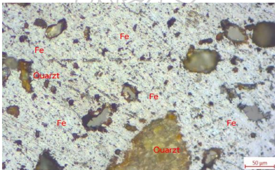
ภาพที่ 62 ลักษณะทางกายภาพและโครงสร้างผลึกของแร่เหล็กฮีมาไทต์จากแหล่งโบราณคดีดอยเหล็กเมื่อส่องในกล้องจุลทรรศน์
