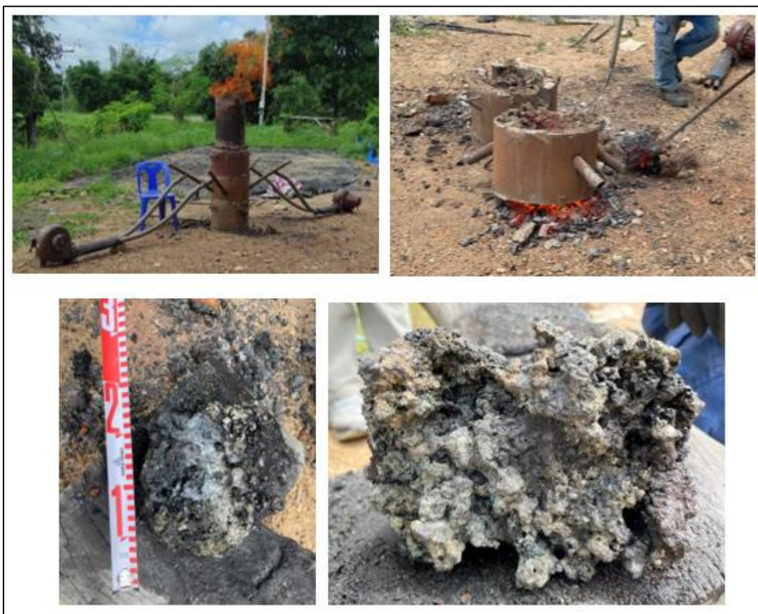
ภาพที่ 101 ก้อนเหล็กแข็งหรือกิ่งของแข็งมีตะกรันปะปน (Bloom) ที่ได้จากการถลุงเหล็กในเตาถลุง BNT OPERATION02/2022
