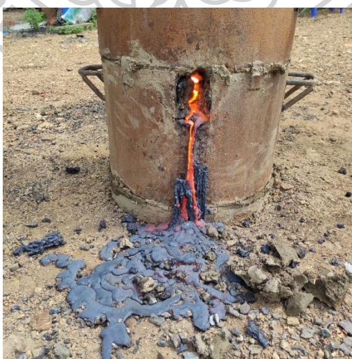
ภาพที่ 104 ตะกรันเหลวหนืดที่ออกจากเตาถลุงเหล็กประยุกต์ BNT OPERATION02/2022 หลังจากมีการสร้างห้องเตาที่สอบแคบ
