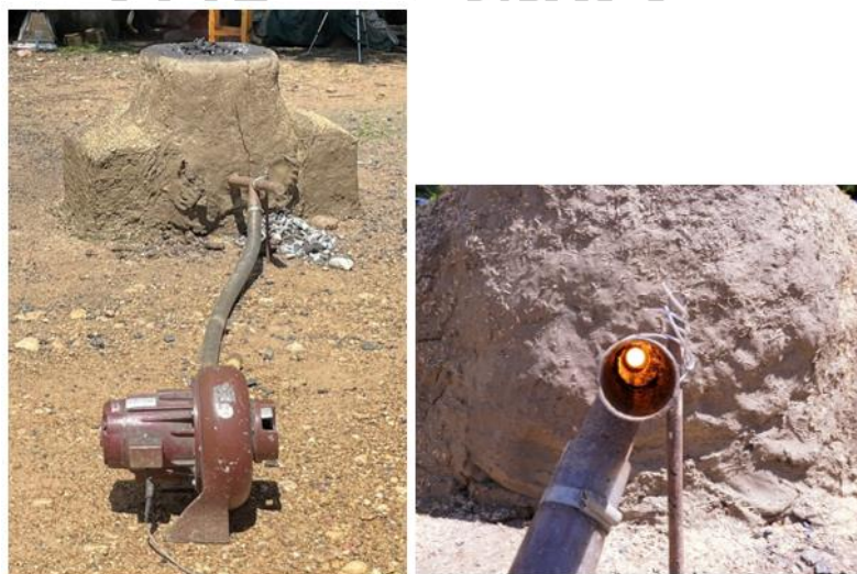
ภาพที่ 96 เครื่องสูบลมและท่อลมที่เป็นโลหะ ของเตาถลุง (BNT OPERATION01/2022)
