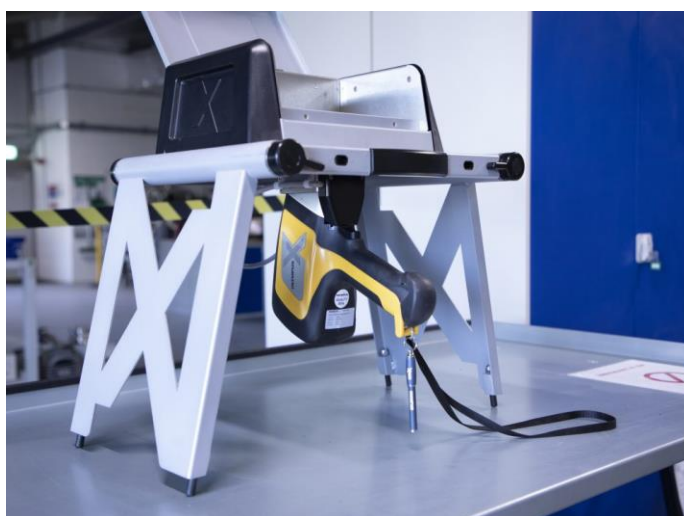
ภาพที่ 40 เครื่องเอกซเรย์ฟลูออเรสเซนซ์แบบพกพา (Handheld x-ray Fluorescence: HHXRF) ยี่ห้อ OLYMPUS รุ่น Delta Professional โหมด Geochem
