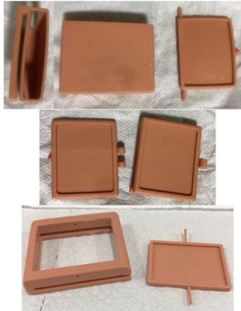
ภาพที่ 68 ชิ้นงานเครื่องประดับคอลเล็คชั่นที่ 1 ที่ขึ้นชิ้นงาน 3 มิติ ในคอมพิวเตอร์และนำมาปริ้นต์ขึ้นรูปด้วยเรซิน
