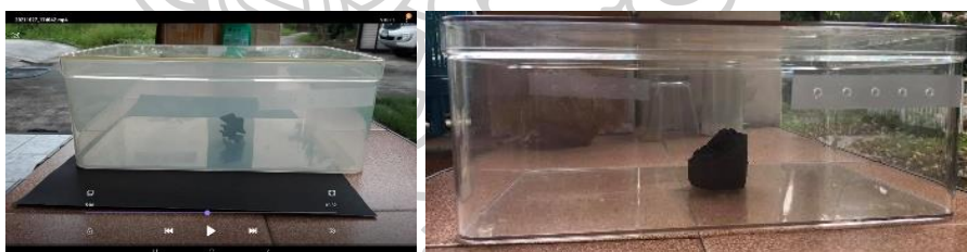
ภาพที่ 42 ภาพจากวิดีโอของชิ้นงานที่มีส่วนผสมจากสูตรที่ 3 (ซ้าย) และก้อนถ่านไม้ไผ่เปล่า ๆ จากการทดลองที่ 2 ในหัวข้อ 3.1 การทดลองวัสดุที่ช่วยลดหรือดูดซับควันทันบูหรี (ขวา) ในช่วง 10 นาทีหลังพ่นควันทันบูหรี
