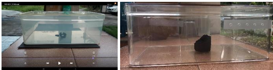
ภาพที่ 40 ภาพจากวิดีโอของชิ้นงานที่มีส่วนผสมจากสูตรที่ 1 (ซ้าย) และก้อนถ่านไม้ไผ่เปล่า ๆ จากการทดลองที่ 2 ในหัวข้อ 3.1 การทดลองวัสดุที่ช่วยลดหรือดูดซับควันทันบูหรี (ขวา) ในช่วง 10 นาทีหลังพ่นควันทันบูหรี
