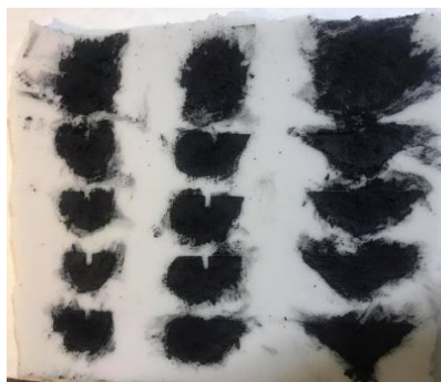
ภาพที่ 38 อัดผงถ่านไม้ไผ่ผสมน้ำเปล่าและกาวผงลงในพิมพ์
