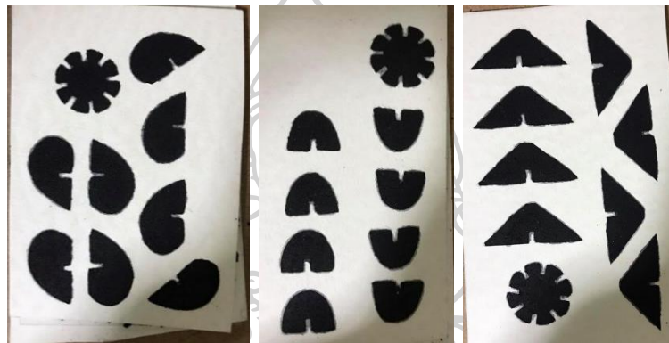
ภาพที่ 36 อัดผงถ่านไม้ผงผสมน้ำเปล่าและกาวน้ำลงในพิมพ์จากกระดาษชานอ้อย
