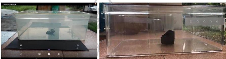
ภาพที่ 41 ภาพจากวิดีโอของชิ้นงานที่มีส่วนผสมจากสูตรที่ 2 (ซ้าย) และก้อนถ่านไม้ไผ่เปล่า ๆ จากการทดลองที่ 2 ในหัวข้อ 3.1 การทดลองวัสดุที่ช่วยลดหรือดูดซับควันทันบูหรี (ขวา) ในช่วง 10 นาทีหลังพ่นควันทันบูหรี
