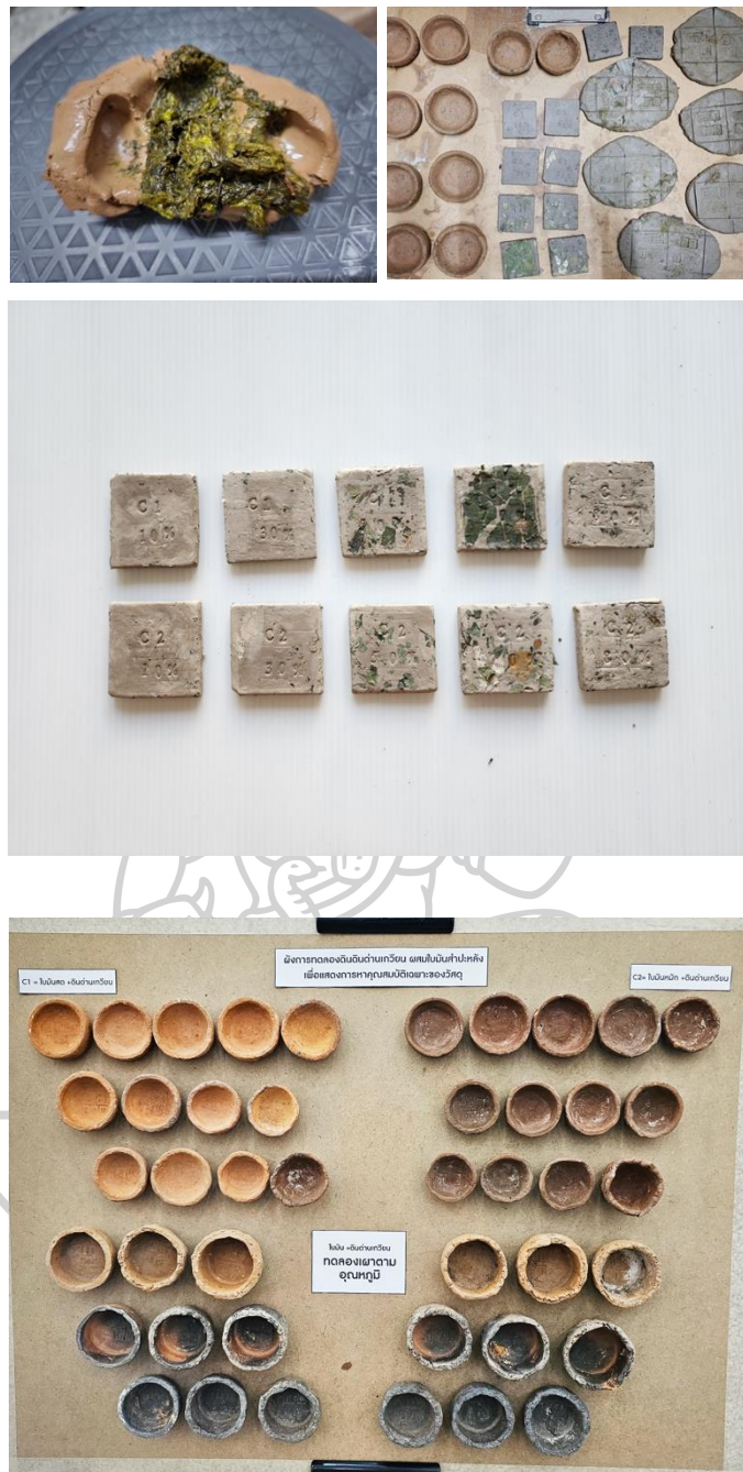
ภาพที่ 56 การทดลองสร้างต้นแบบงานหัตถกรรม ดินเหนียวผสมกับไขมันสำปะหลัง
