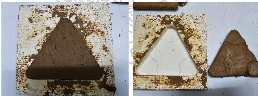
ภาพที่ 44 ชิ้นงานดินดิบเมื่อถอดออกจากพิมพ์ก่อนนำเข้าเตาเผา
