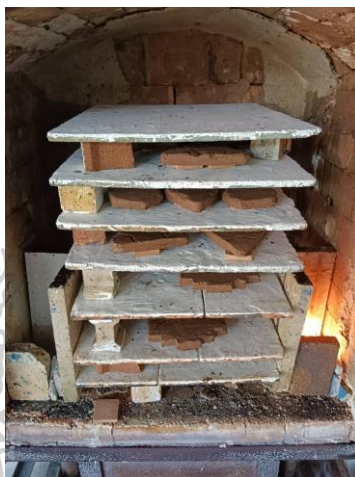
ภาพที่ 45 จัดเรียงนำชิ้นงานเข้าเตาเผา โดย: อาภาพร สดกำปัง (4 มีนาคม 2566)
