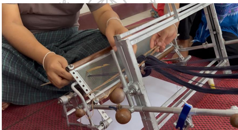
ภาพที่ 97 ใช้ไม้ซุงรูปพีมช่วยในการนำเส้นฝ้ายผ่านพีมทีละเส้น โดย 1 ช่องจะมีเส้นฝ้ายผ่าน 2 เส้น ที่มา : ผู้วิจัย
