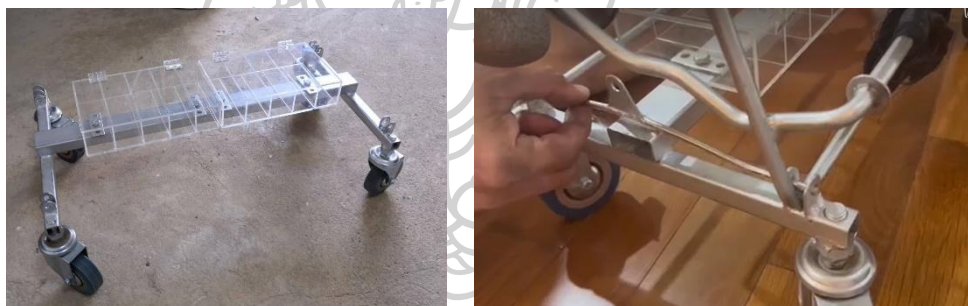
ภาพที่ 87 ภาพซ้าย ภาพส่วนฐานเมื่อนำกล่องอคริกมาประกอบ ภาพขวาเหล็กที่ใช้ล็อกตัวฐานกับที่ทอผ้าตัวต้นแบบ ที่มา : ผู้วิจัย
