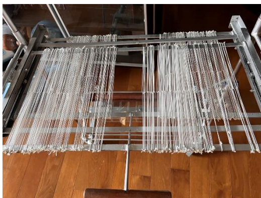
ภาพที่ 92 เส้นตะกอไอนลอน ทั้งหมด ฝingle 227 เส้น
