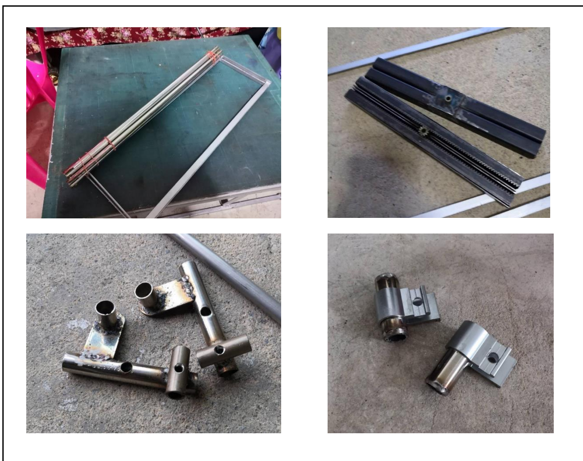
ภาพที่ 76 ภาพซ้ายเจาะไม้ม้วนผ้า และทำเหล็กเป็นตัวล็อคผ้า
