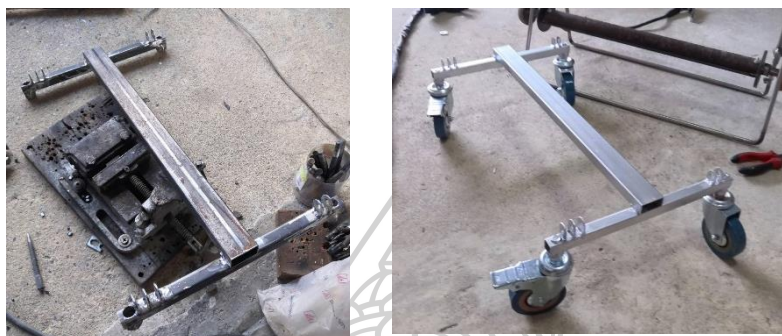
ภาพที่ 86 ภาพขวา ขั้นตอนการทำส่วนฐาน ภาพซ้ายส่วนฐานเมื่อเสร็จแล้วติดล้อ ที่มา : ผู้วิจัย
