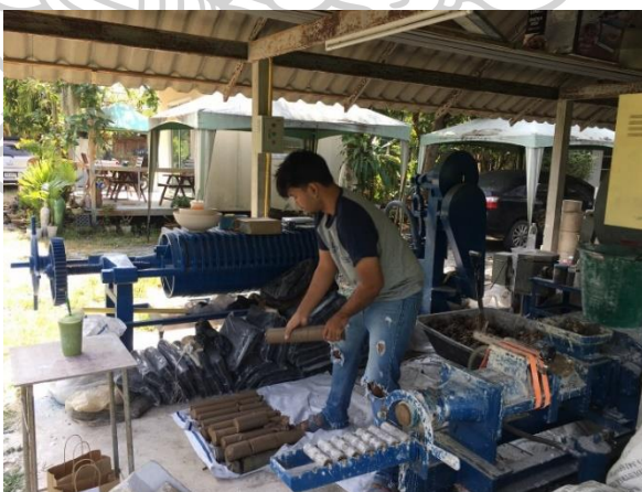
ภาพที่ 27 การนำดินที่หมักเข้าเครื่องรีดดินเพื่อที่จะสามารถใช้งานได้ ถ่ายเมื่อ เดือนกุมภาพันธ์ 2566 โดย ธนพร ศรีหงษ์
