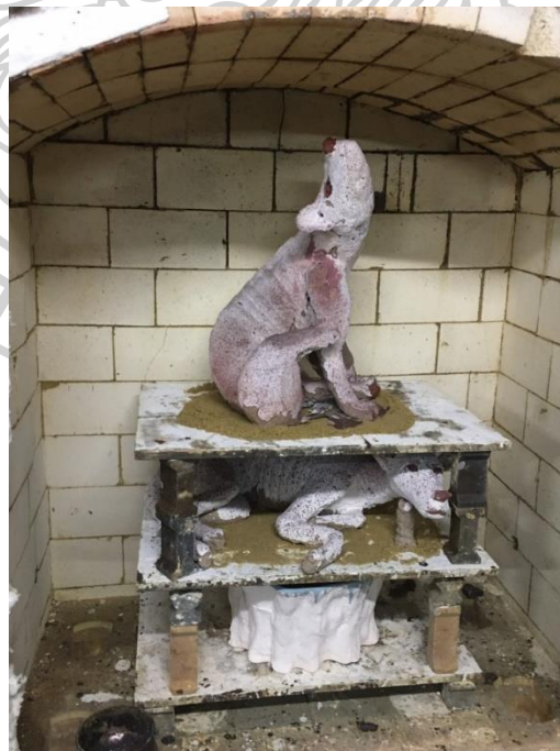
ภาพที่ 34 การโหลดชิ้นงานเข้าเตาเผา ถ่ายเมื่อ เดือนกุมภาพันธ์ 2566 โดย ธนพร ศรีหงส์
