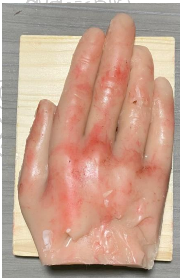
รูปภาพที่ 100 ภาพการทดลองทำผิวหนังมนุษย์จากยางซิลิโคน Premium Grade (ผลงานชุดที่4)
