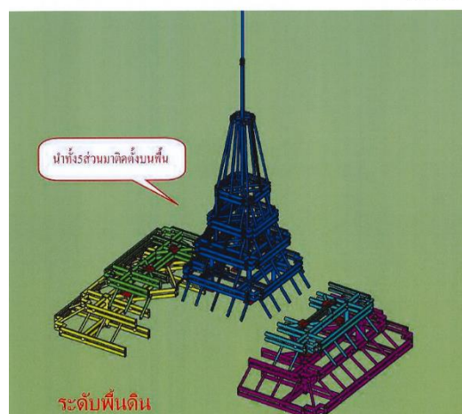
ภาพที่ 37 แสดงการแบ่งส่วนประกอบติดตั้งโครงสร้างเหล็กส่วนบน 5 ส่วน ณ.สถานที่ก่อสร้าง
