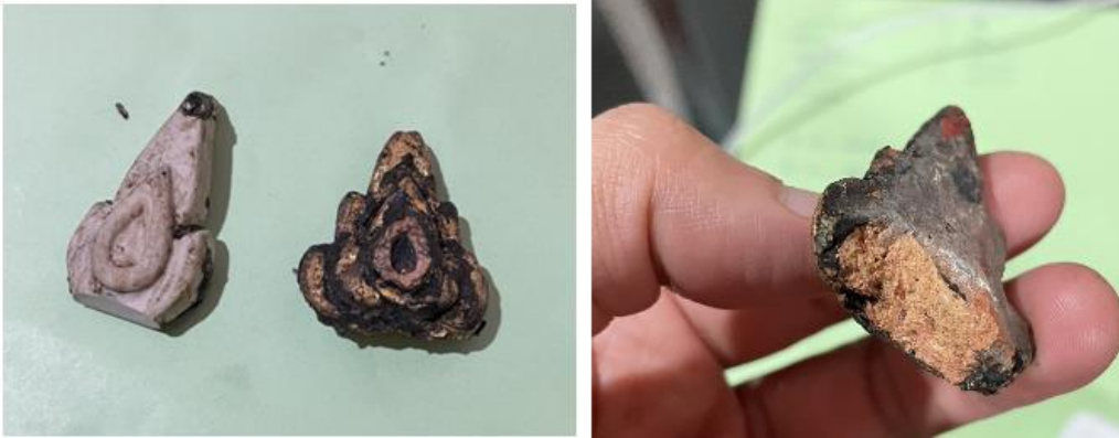
ภาพที่ 99 การเปรียบเทียบกระจังเซรามิคสำเร็จรูป และกระจังดินเผา
