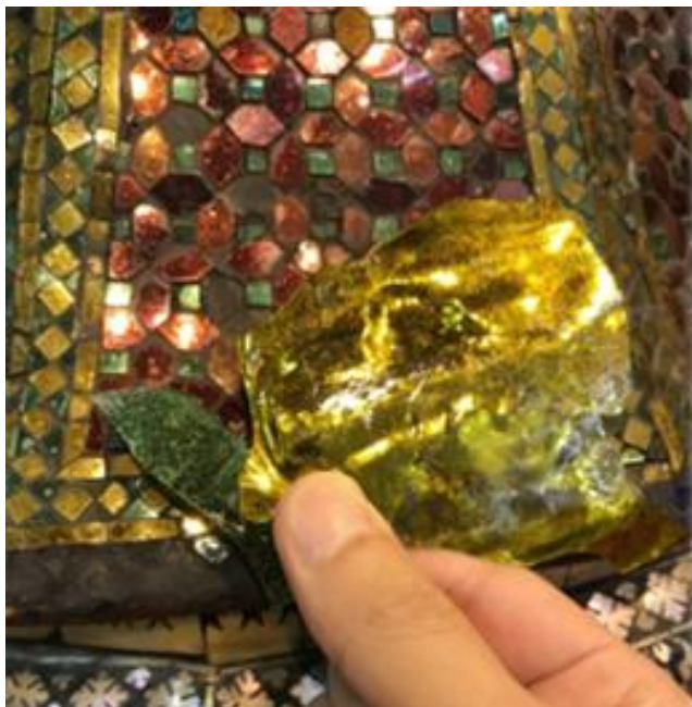
ภาพที่ 73 การขยายผลนำกระจกเงาที่ประดิษฐ์ขึ้นโดยใช้สูตรเคมีของกระจกเงาประดับลายปูนปั้นประดับพระเขนย พระพุทธไสยาส มาใช้บูรณะงานศิลปกรรมสมัยต้นรัตนโกสินทร์ภายในวัด เช่น เตียบ ตะลุ่มประดับกระจกเงา
