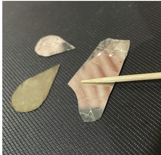
ภาพที่ 29 กระจกที่สั่งซื้อจากประเทศจีนเป็นกระจกแก้วบาง ที่มีคุณสมบัติเช่นเดียวกับ กระจกเงาระนาบ แต่มีความหนาประมาณ 1 มิลลิเมตร
