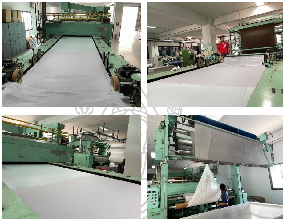
ภาพที่ 31 การนำผ้าเข้าสู่กระบวนการทดสอบต้านแบคทีเรีย ที่มา : สถาบันพัฒนาอุตสาหกรรมสิ่งทอ เมื่อวันที่ 31 มีนาคม 2566
