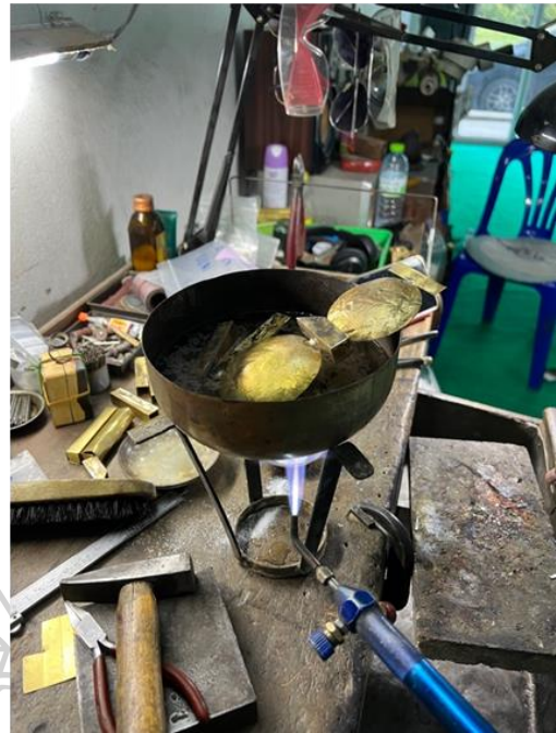
ภาพที่ 68 ขึ้นตัวเรือนรอบที่ 1 ด้วยมือ โดยวัสดุทองเหลือง ที่มา : ผู้วิจัย 31 สิงหาคม 2566
