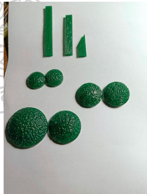
ภาพที่ 69 ขึ้นตัวเรือนรอบที่ 2 ด้วยแว็กซ์ ก่อนนำไปหล่อ ที่มา : ผู้วิจัย 3 ตุลาคม 2566
