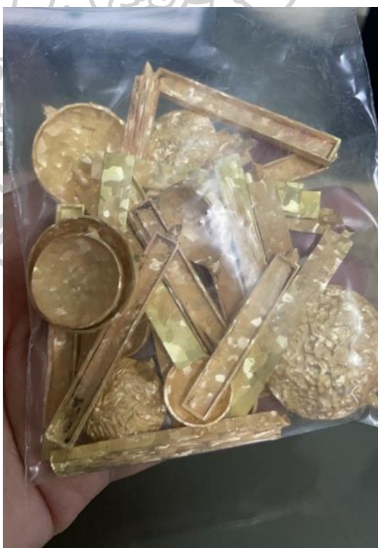
ภาพที่ 71 ชิ้นงานทองเหลืองหลังการหล่อโลหะ ที่มา : ผู้วิจัย 4 ตุลาคม 2566
