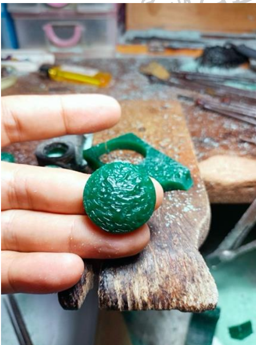
ภาพที่ 69 ขึ้นตัวเรือนรอบที่ 2 ด้วยแว็กซ์ ก่อนนำไปหล่อ ที่มา : ผู้วิจัย 3 ตุลาคม 2566
