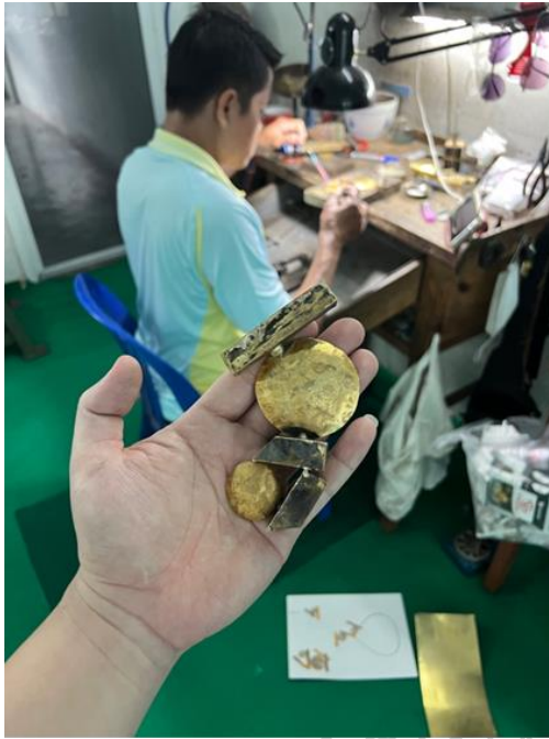
ภาพที่ 68 ขึ้นตัวเรือนรอบที่ 1 ด้วยมือ โดยวัสดุทองเหลือง ที่มา : ผู้วิจัย 31 สิงหาคม 2566
