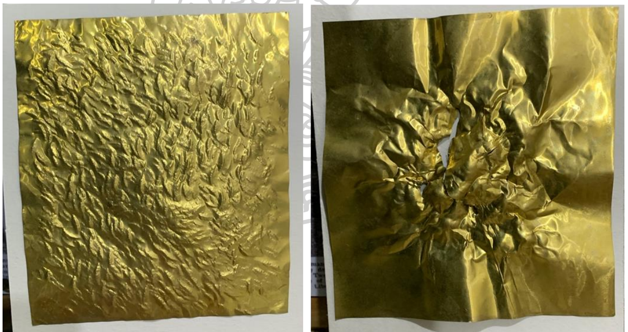
ภาพที่ 41 การขึ้นรูปโดยตีด้วยค้อนและตุลลายด้วยโลหะ ที่มา: ผู้วิจัย 19 กุมภาพันธ์ 2565
